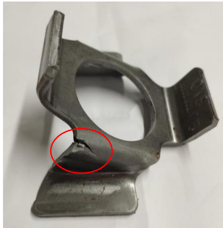
Figura 108 - Fissuras ocorridas na peça 16365
