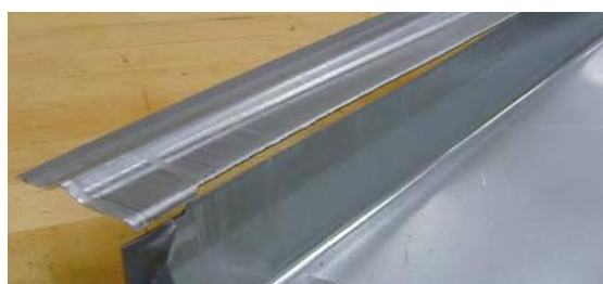
Figura 31 - Exemplo de fratura por shear fracture [13]
