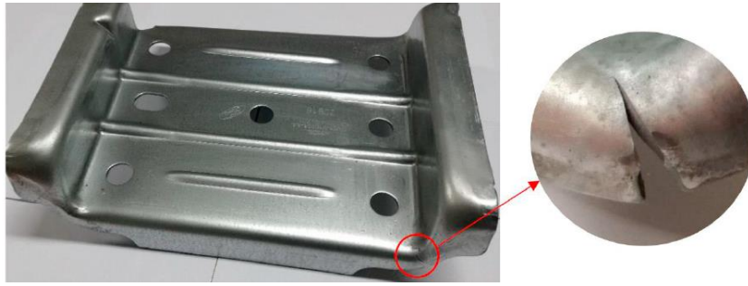
Figura 29 - Exemplo do aparecimento de uma edge crack [48]
