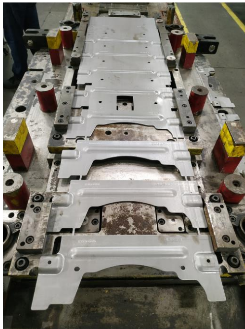
Figura 26 - Banda metálica obtida numa ferramenta progressiva
