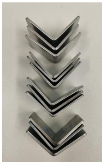
Figura 61 - Provetes do aço DP800 após o ensaio de flexão
