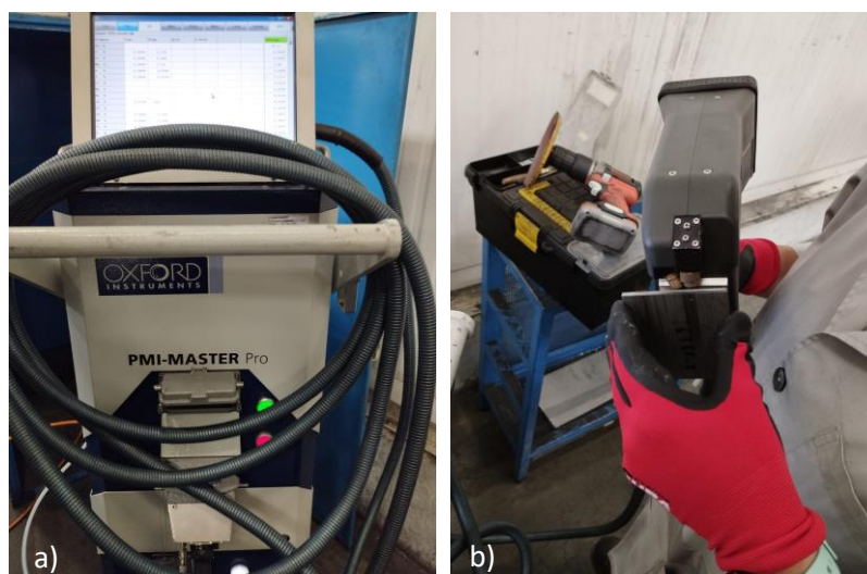
Figura 52 – a) Equipamento PMI - Master Pro; b) Execução do ensaio
