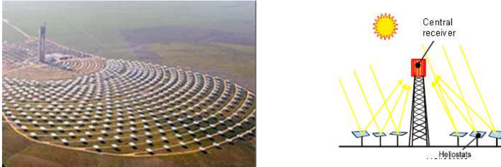
Figura 76 Esquema de concentrador torre solar [42] [43]
