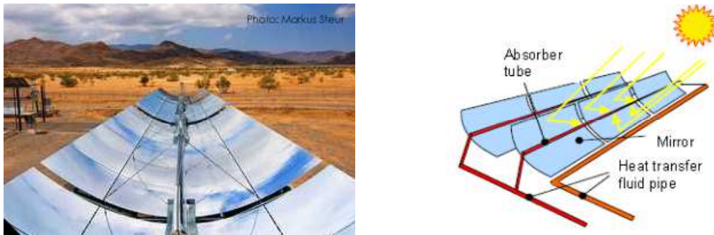
Figura 71 Esquema de concentrador cilindro-parabólico [42] [43]
