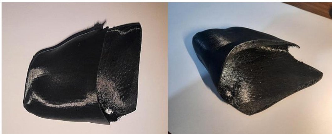
Figura 51 – Ortótese em TPU Filaflex 82A com alterações.
