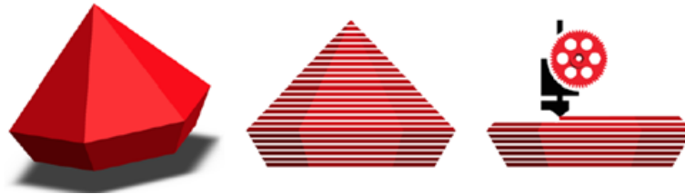
Figura 14 – Apresentação da obtenção de uma peça por impressão 3D [44].
