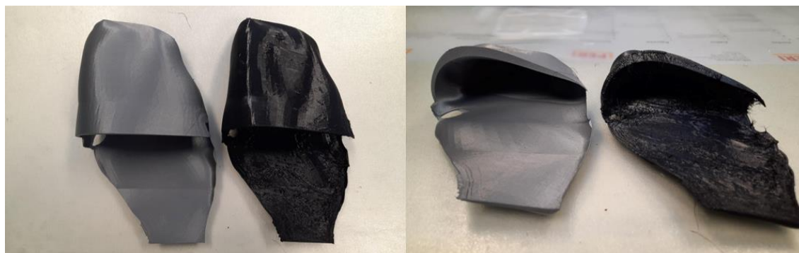
Figura 49 – Ortótese resultante da impressão 3D em PLA e TPU, respetivamente.
