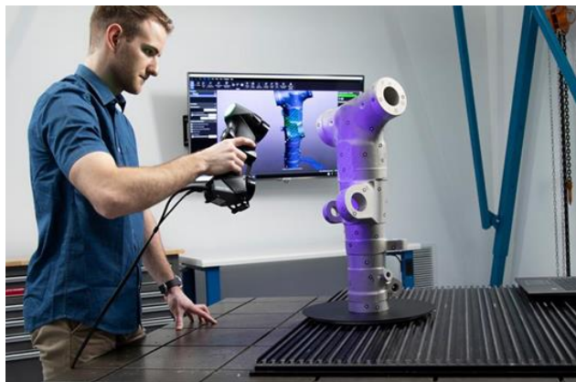
Figura 11 – Exemplo de como fazer o scan de uma peça em mesa fixa [38].
