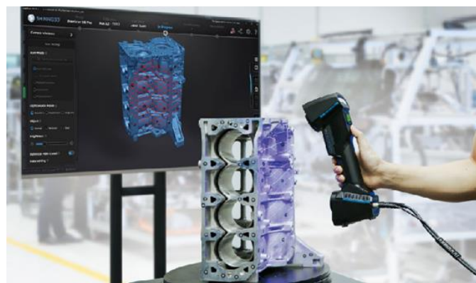
Figura 10 – Scanner manual 3D com integração da fotogrametria [36].
