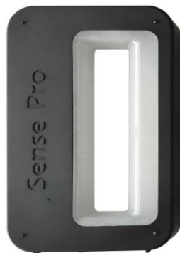
Figura 21 - Scanner 3D de mão Sense Pro de alta precisão [70].
