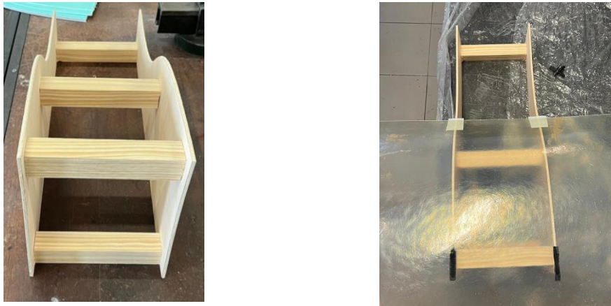
Figura 26 - Molde para dobragem do PVC. (a) Estrutura em madeira. (b) Estrutura com a placa rígida.
