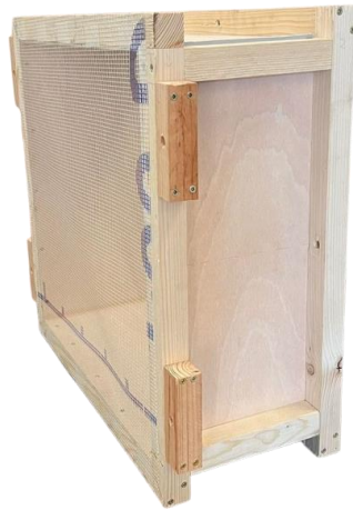
Figura 36 - Câmara de estabilização.
