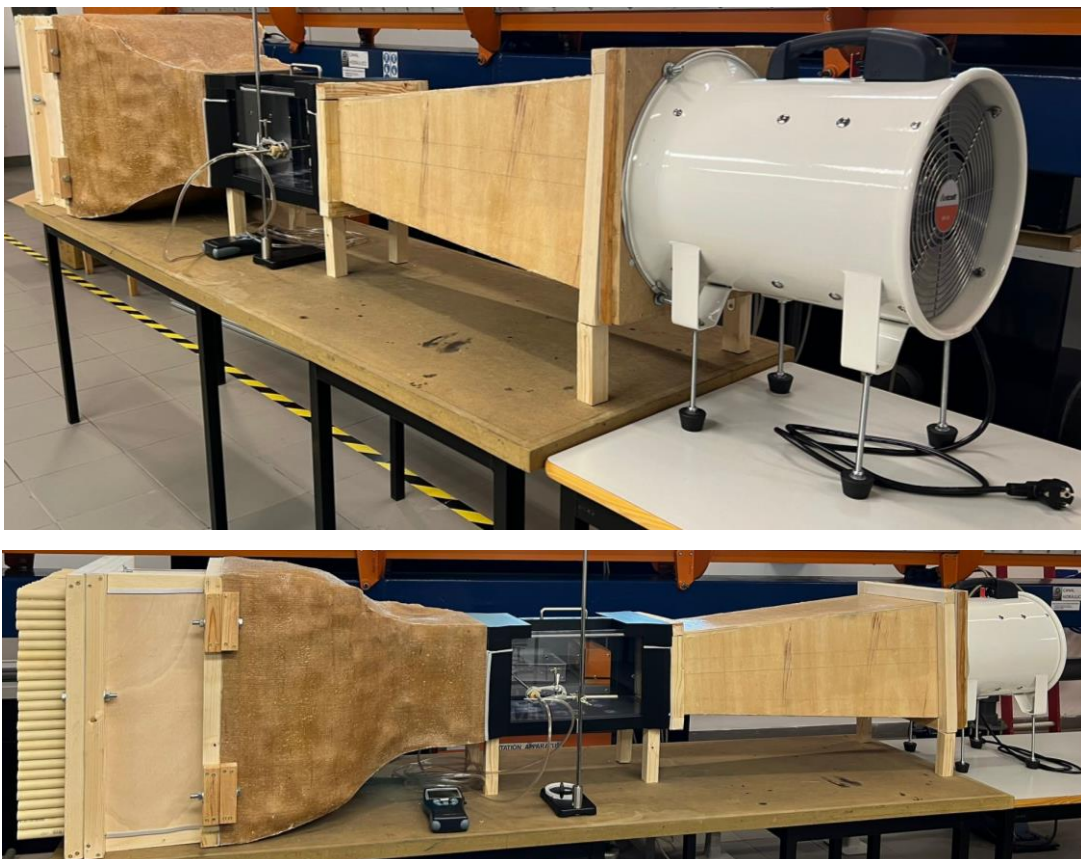
Figura 49 - Túnel de vento finalizado.
