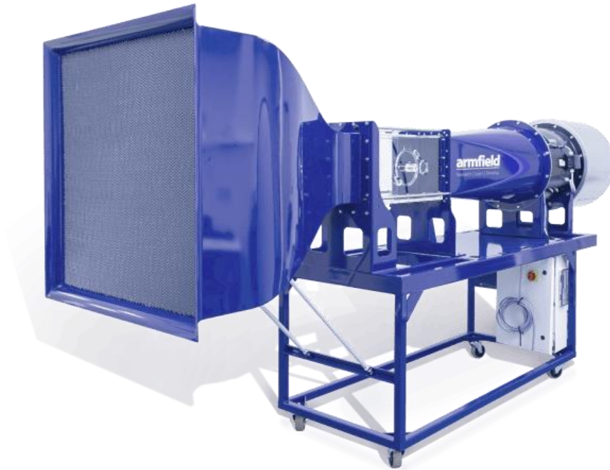
Figura 51 - Túnel de vento Armfield C30, extraído de (Armfield, 2020).
