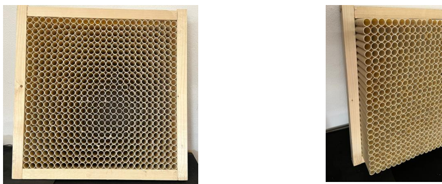
Figura 35 - Estrutura do favo de abelha finalizada.
