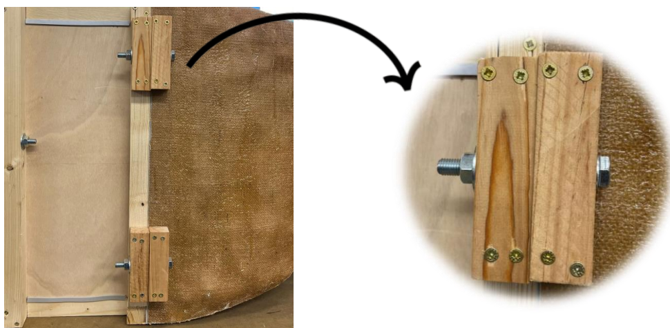
Figura 39 - Modo de acoplamento da contração à câmara de estabilização.
