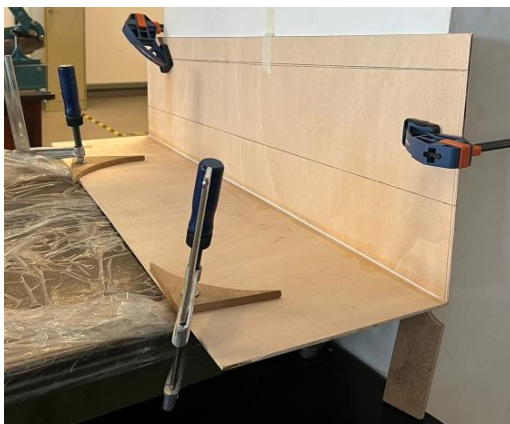
Figura 40 - Difusor. (a) Processo de corte. (b) Colagem.
