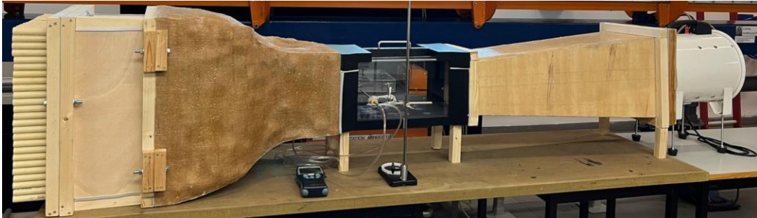
Figura 52 - Túnel de vento construído.
