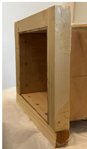
Figura 41 - Ripas de madeira aparafusadas na secção de entrada do difusor.
