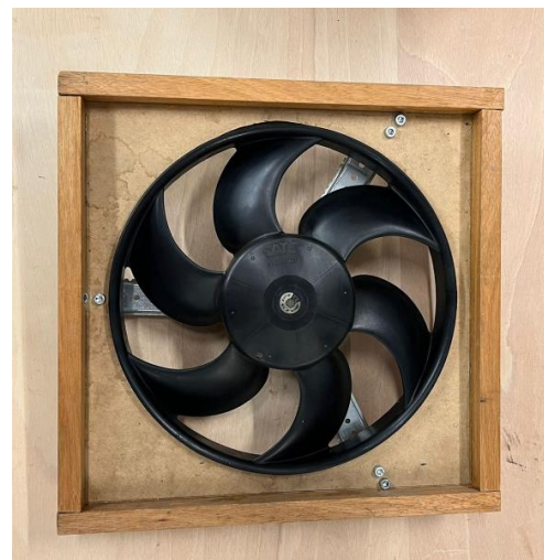
Figura 42 - Ventilador. (a) Modo de fixação. (b) Vedação da secção de saída do difusor.
