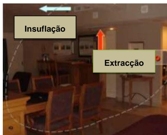
Figura 8 Insuflação e extracção distanciadas; eficiência de 80%
