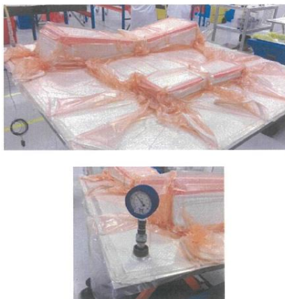
Figura 7- Molde com peça fechada em saco de vácuo
