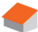
Cobertura de uma água
