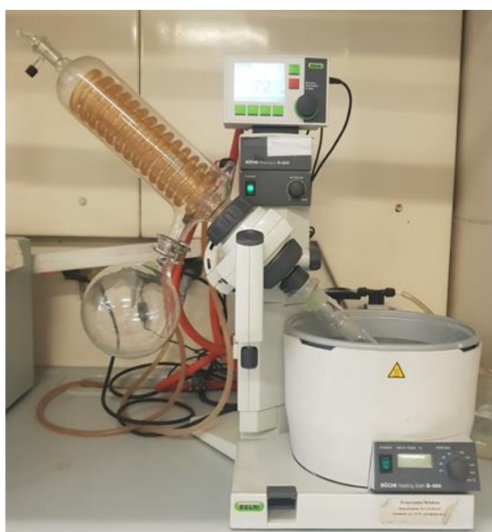
Figura 2-4 - Etapa de evaporação dos extratos em rotavapor.
