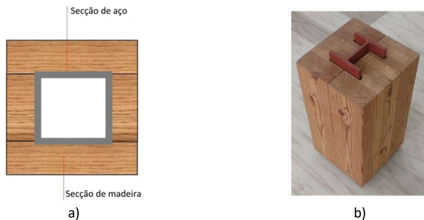
Figura 3 - Elementos de construção aço-madeira: a) Secção quadrada (adaptado de [34]), b) Secção em I [30].
