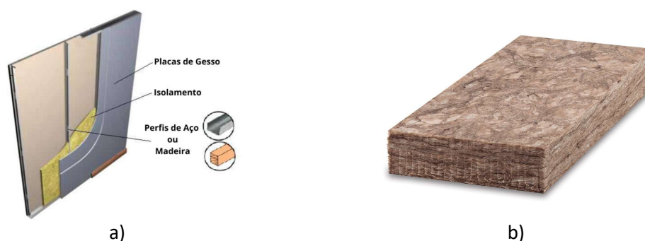
Figura 2 - Sistemas de isolamento: a) Placas de Gesso (adaptado de [22]), b) Painel de Lã Mineral [25].
