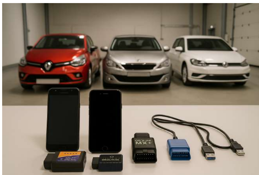
Figura 8.1: Configuração Laboratorial dos Testes Forenses Ambiente de teste, com adaptadores OBD-II ELM327, OBDLink MX+ e Adaptador USB OTG
