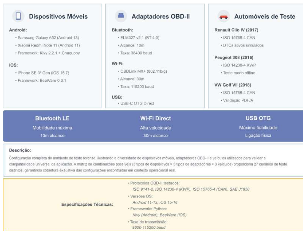
Figura 8.5: Ambiente de Teste: Dispositivos, Adaptadores e Automóveis
