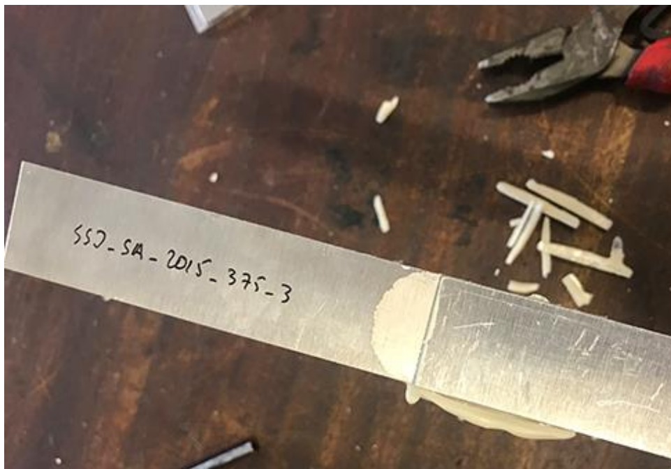
Figura 29 – Operação de limpeza do excesso de adesivo e respetiva marcação do provete.
