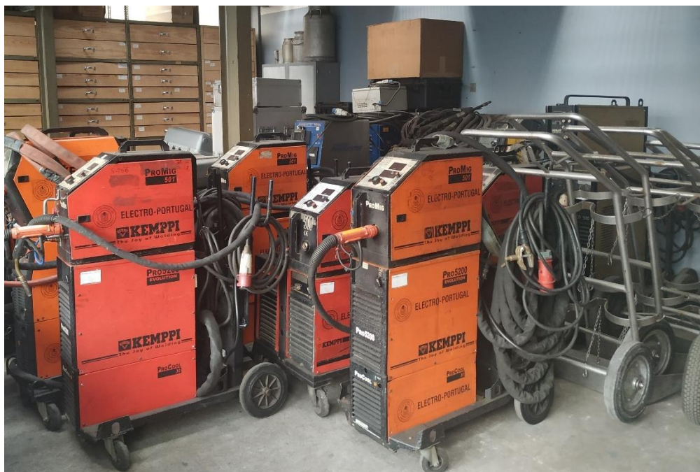
Figura 23 – Máquinas de soldar e equipamentos de apoio ao processo.
