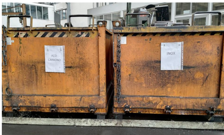
Figura 40 - Separação de sucatas metálicas.
