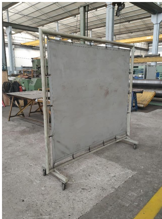
Figura 38 – Barreira de Proteção com sistema de rodas.
