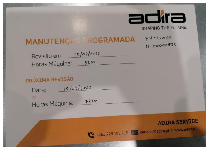
Figura 37 - Exemplo da folha de identificação de manutenção colocada na máquina
