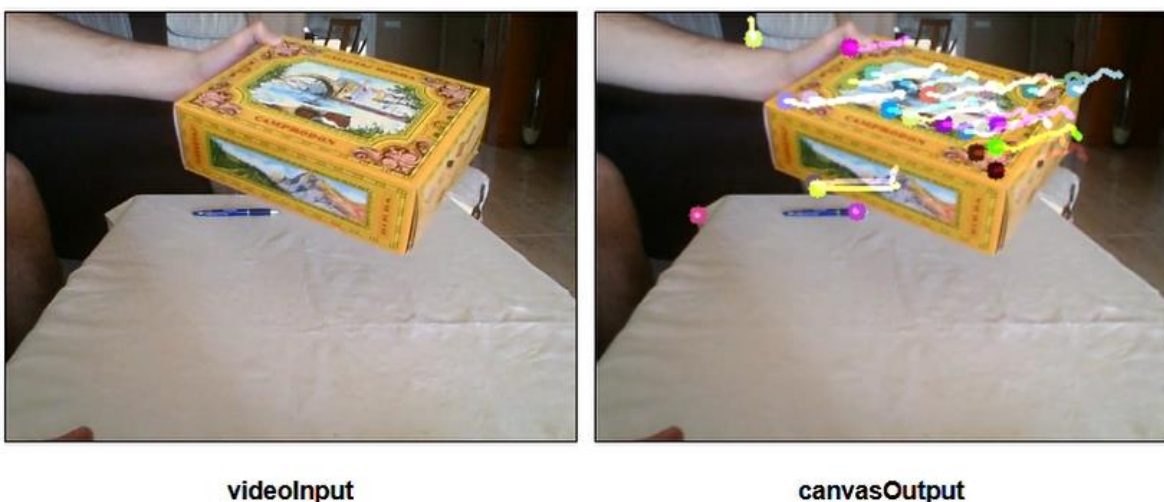
Figura 19 Exemplo Lucas-Kanade Optical Flow – Deslocamento dos Pontos a Rastrear [49]
