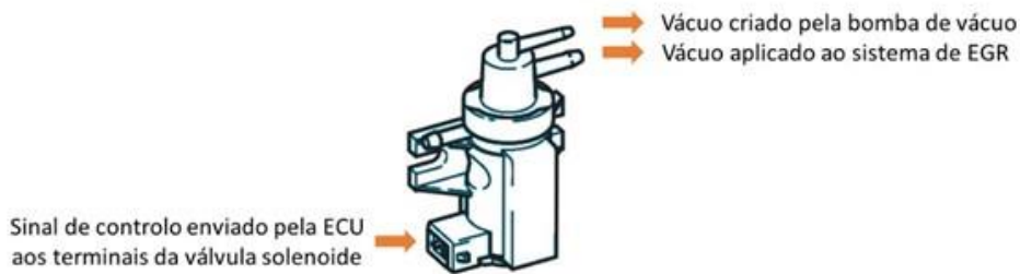
Figura 10- Válvula solenoide de controle do mecanismo da EGR com recurso a vácuo
