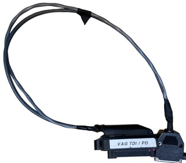
Figura 31 - Cabo específico para unidades de controlo do motor EDC15P+
