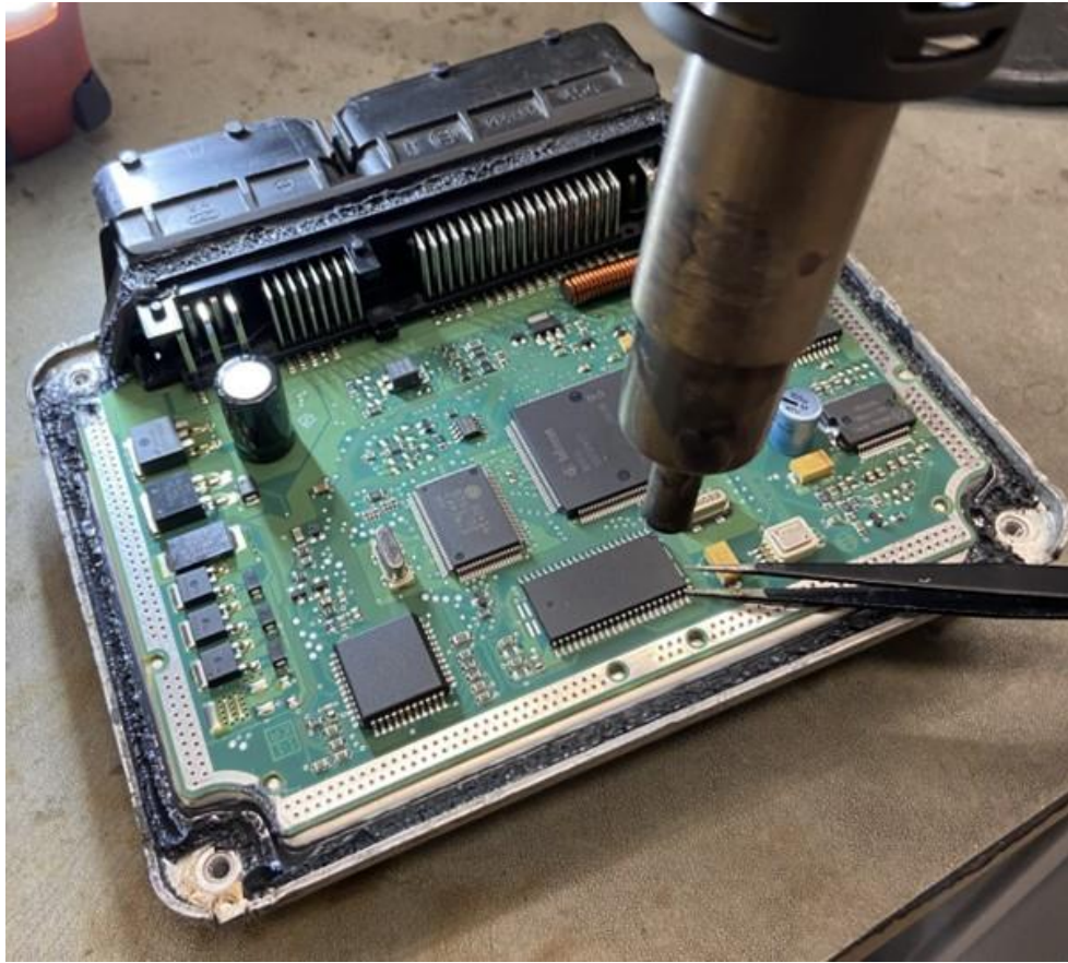
Figura 61 - Remoção da FLASH da ECU
