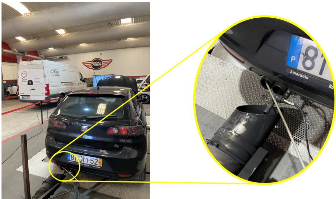
Figura 72 – Instalação do analisador de gases e da sonda lambda no escape
