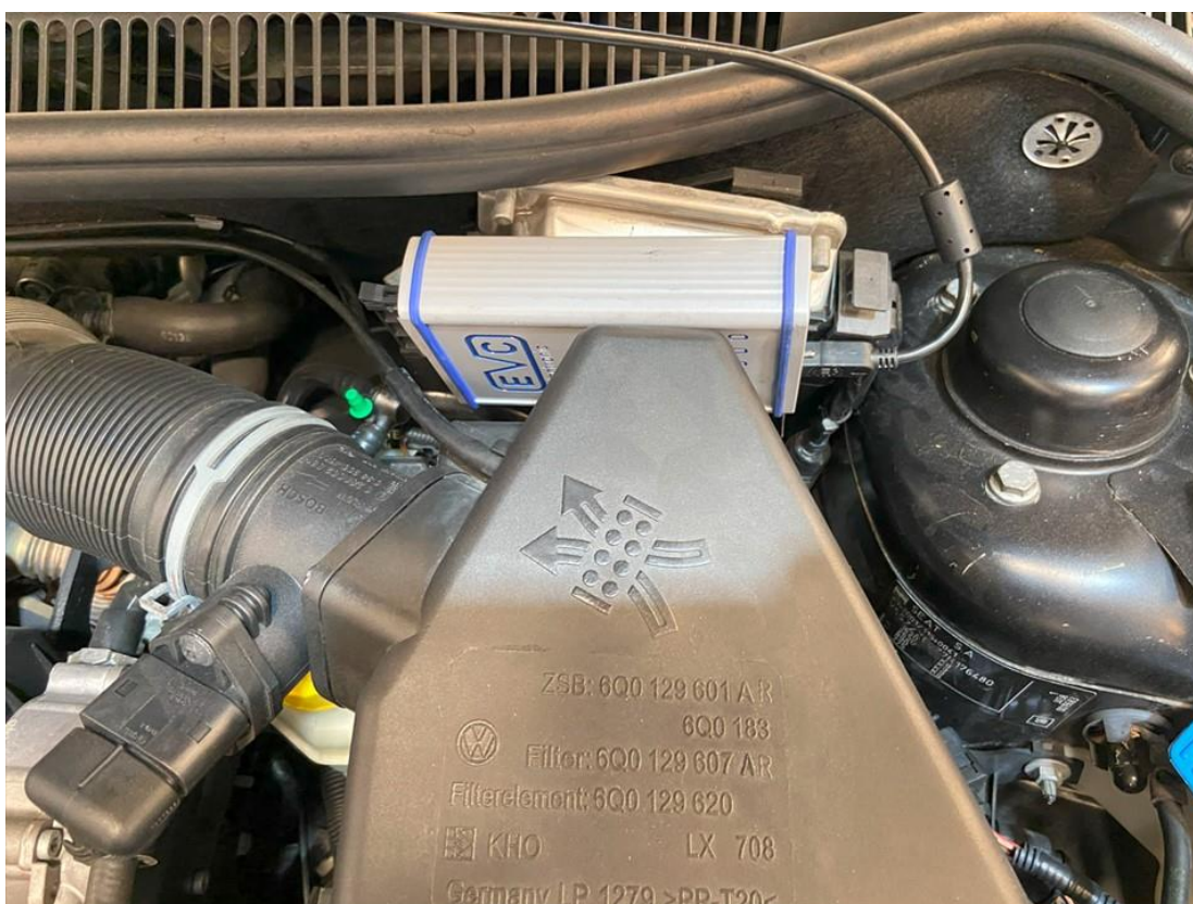
Figura 66 - Substituir a ECU original do veículo pela ECU de testes incorporada com o emulador OLS 300
