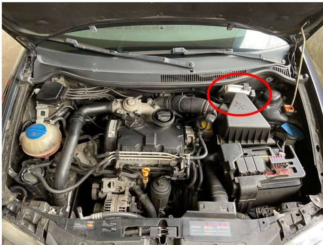
Figura 27 - Localização da Unidade de Controlo do Motor
