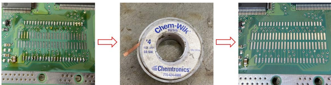
Figura 62 - Remoção do excesso de solda com recurso a malha de cobre e a um ferro de soldar a estanho
