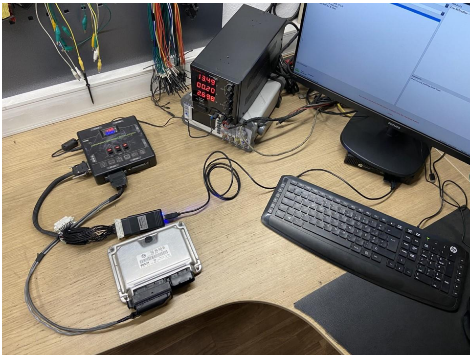
Figura 35 - Apresentação do esquema base para a leitura da informação da unidade de controlo do motor
