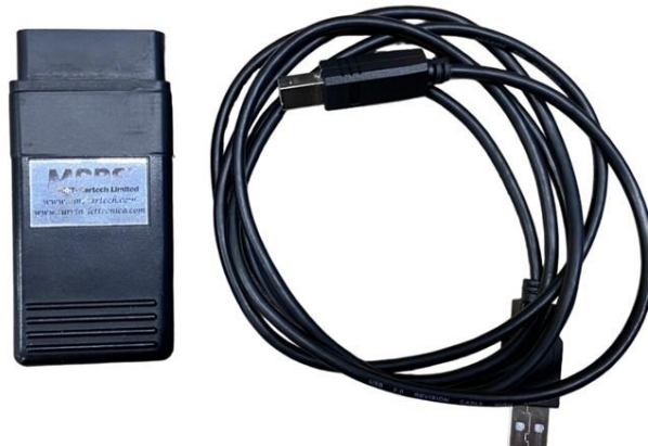
Figura 34 - Equipamento de diagnóstico e de reprogramação de unidades de controlo do motor
