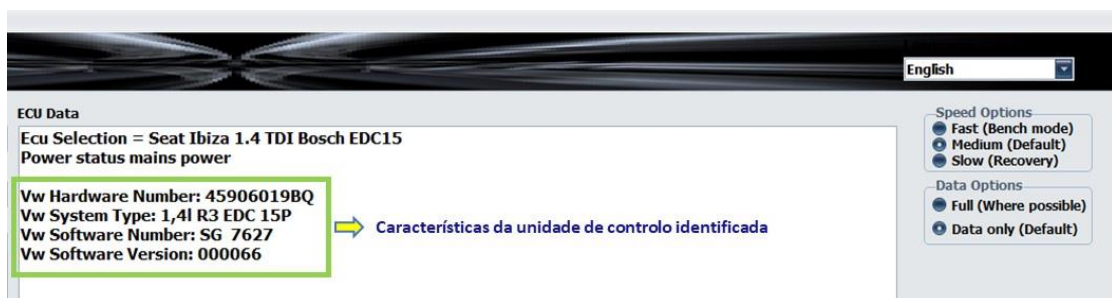
Figura 37 - Características apresentadas no MPPS após a identificação da unidade de controlo do motor
