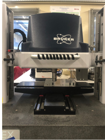
(a) Bruker NPFLEX-1000 apparatus.
