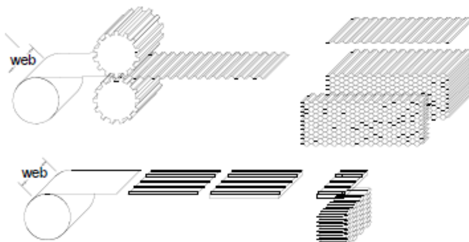
Figura 4 - Fabrico do ninho de abelha [4]
