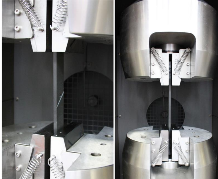
Figura 19 - Ensaio de tração segundo a norma ASTM D3039 [23]
