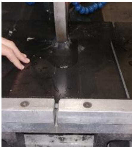
Figura 50 - Retificação da estrutura e corte dos provetes
