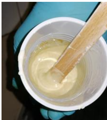
Figura 47 - Mistura do adesivo
