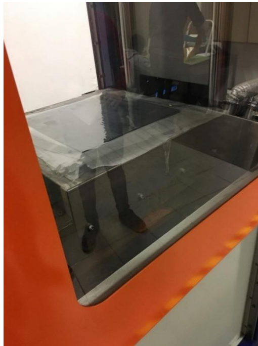
Figura 42 - Colocação dos laminados na prensa de pratos quentes
