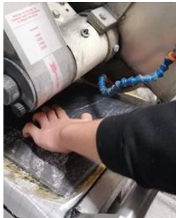
Figura 45 - Corte dos laminados na serra circular
