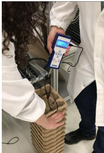
Figura 82 - Medição da força exercida na remoção dos inserts
