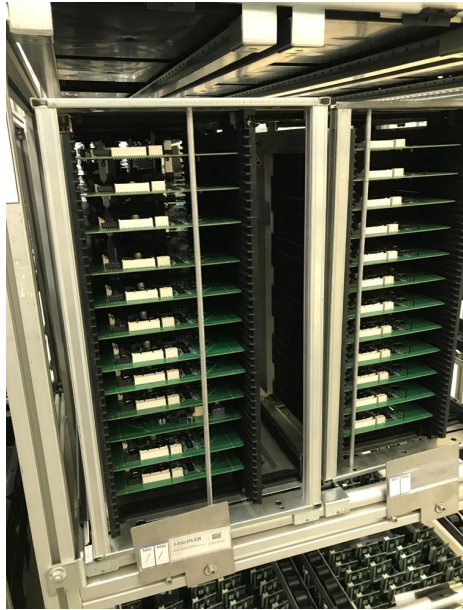
Figura 35 - Exemplo de cassete de PCBA
