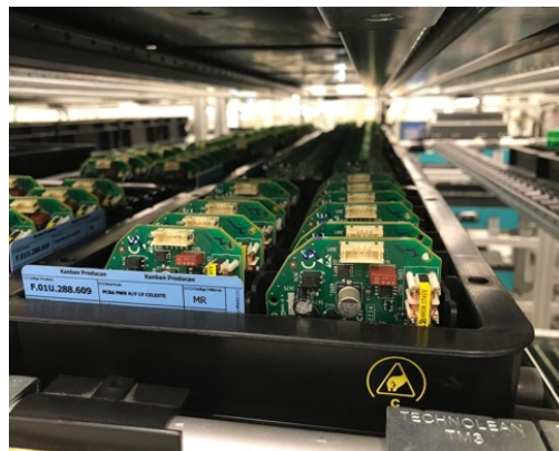
Figura 36 - Exemplo de contentor de PCBA
