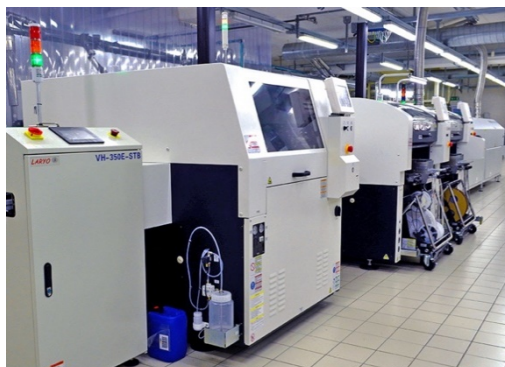
Figura 32 - Exemplo de uma linha de SMT
