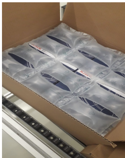
Figura 75 - Colocação de bubble bags
