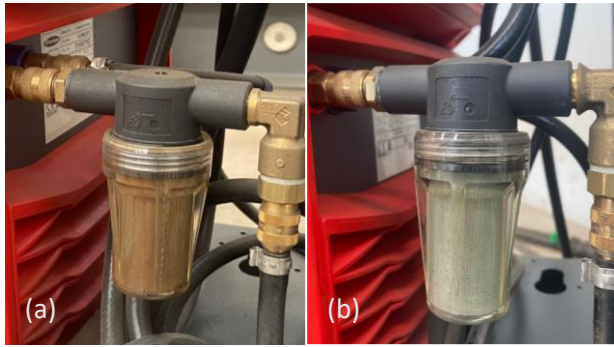
Figura 52- Limpeza do filtro de água (FRONIUS)
