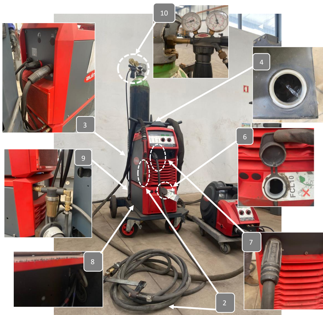
Figura 34- Identificação das principais paragens não programadas nas máquinas de soldadura MIG MAG
