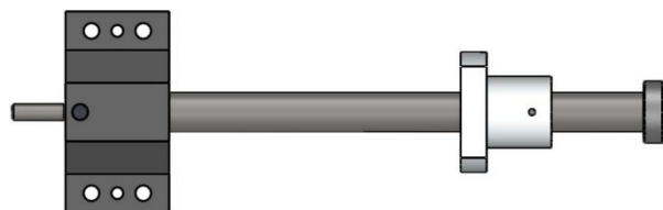
Figura 84 - Perspetiva de topo do sistema de fuso, com 12 mm de diâmetro e 155 mm de comprimento
