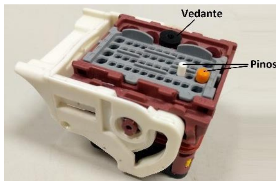
Figura 54 - Pinos e vedante inseridos no conetor a trabalhar
