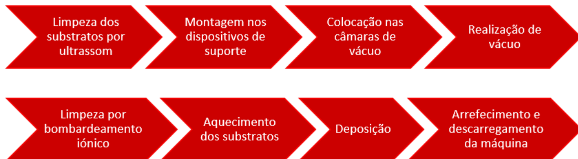
Figura 10 - Etapas do processo PVD, adaptado de [48]
