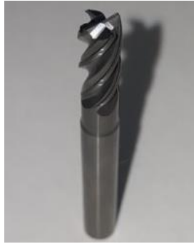
Figura 24 – Exemplo de fresa não revestida usada nos ensaios de corte
