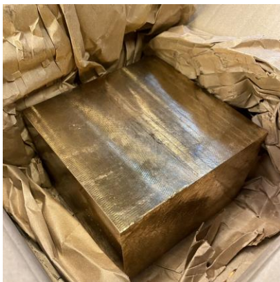
Figura 23 - Bloco de material de base (AMPCOLOY®83) usado nas operações de fresagem
