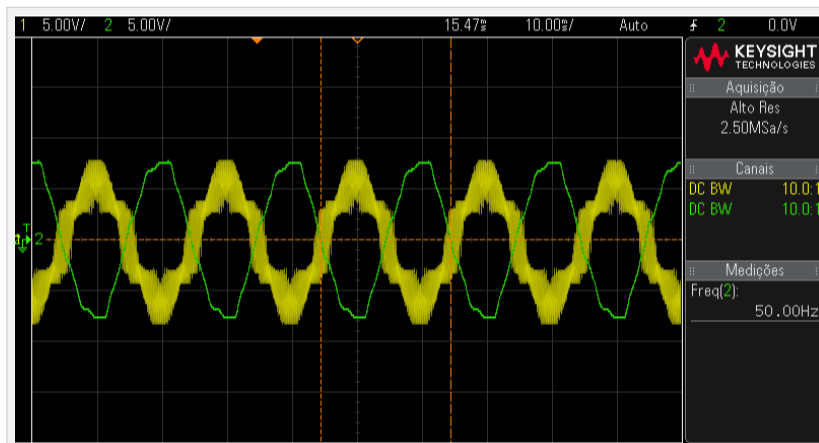
Figura 5.13: Desfasamento entre as Tensões Produzidas no Conversor (Amarelo) e as Tensões da Rede (Verde).
