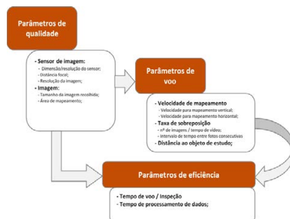
Figura 1. Parâmetros a ter em conta ao efetuar uma inspeção com drone (adaptado a partir de [3]).
