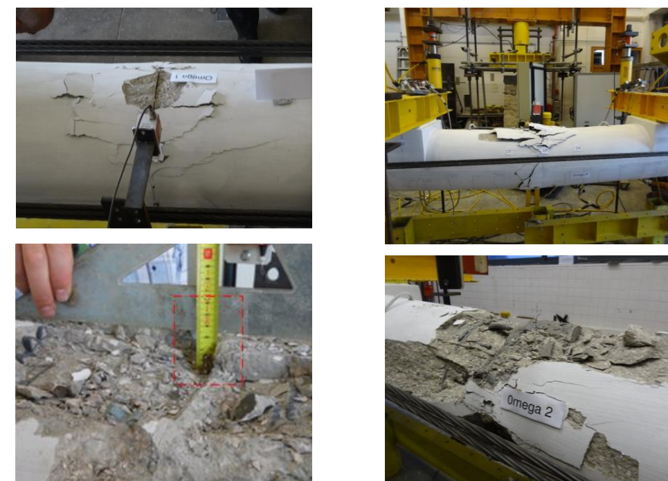
Figura 2. Aspecto do modelo S3 na rutura (à esquerda); Aspecto do modelo S4 na rutura (à direita)
