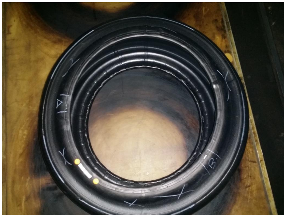
Figura 3.15. Pneu acompanhado na produção com as respectivas marcações, antes de ingressar na Vulcanização.
