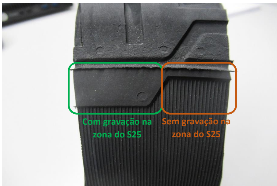
Figura 3.24. Exemplo de uma secção que contém gravações na zona do S25.
