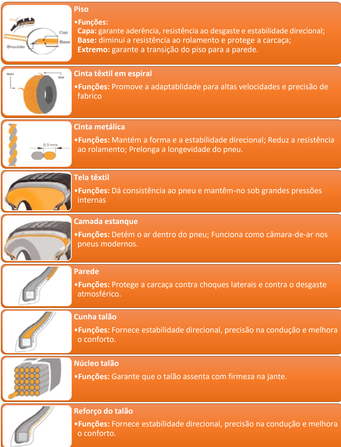
Figura 1.12. Constituintes do pneu e as respetivas funções [4].
