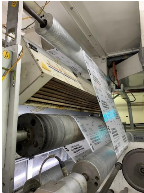
Figura 19 - Estação de tratamento corona
