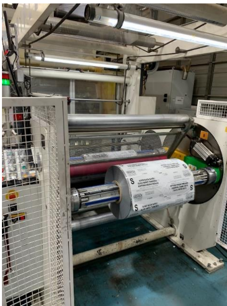
Figura 26 - Bobinagem do filme no bobinador
