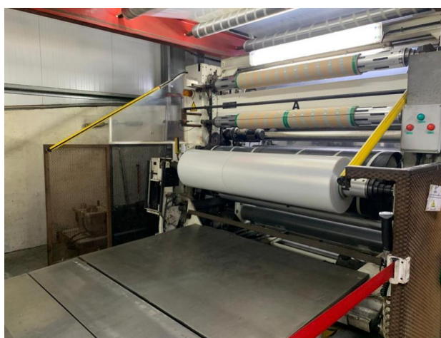
Figura 12 – Bobinagem de PE
