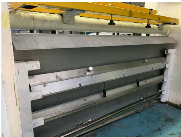
Figura 29 - Local reforçado com proteção destinado à substituição de lâminas
