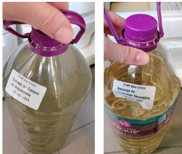
Figura 13 - Amostras de água à entrada do tanque de arejamento (à esquerda) e no decantador secundário (à direita) cedidas pela SimDouro.
