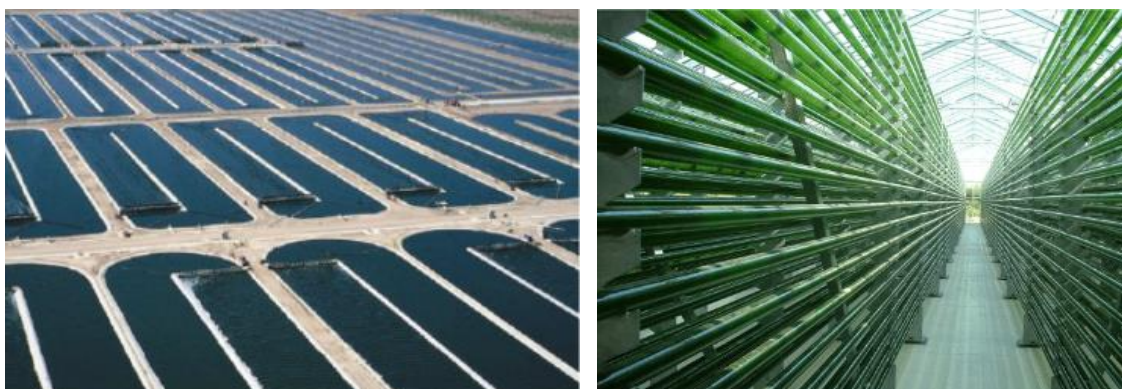
Figura 5 - Reatores tipo raceway (à esquerda) e FBR tubular (à direita). Retirado de Oliveira (2009).
