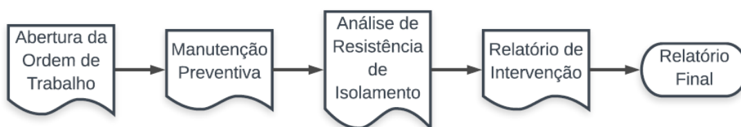
Figura 56 - Diagrama do procedimento de preenchimento da documentação em trabalhos de manutenção preventiva antes da implementação do software
