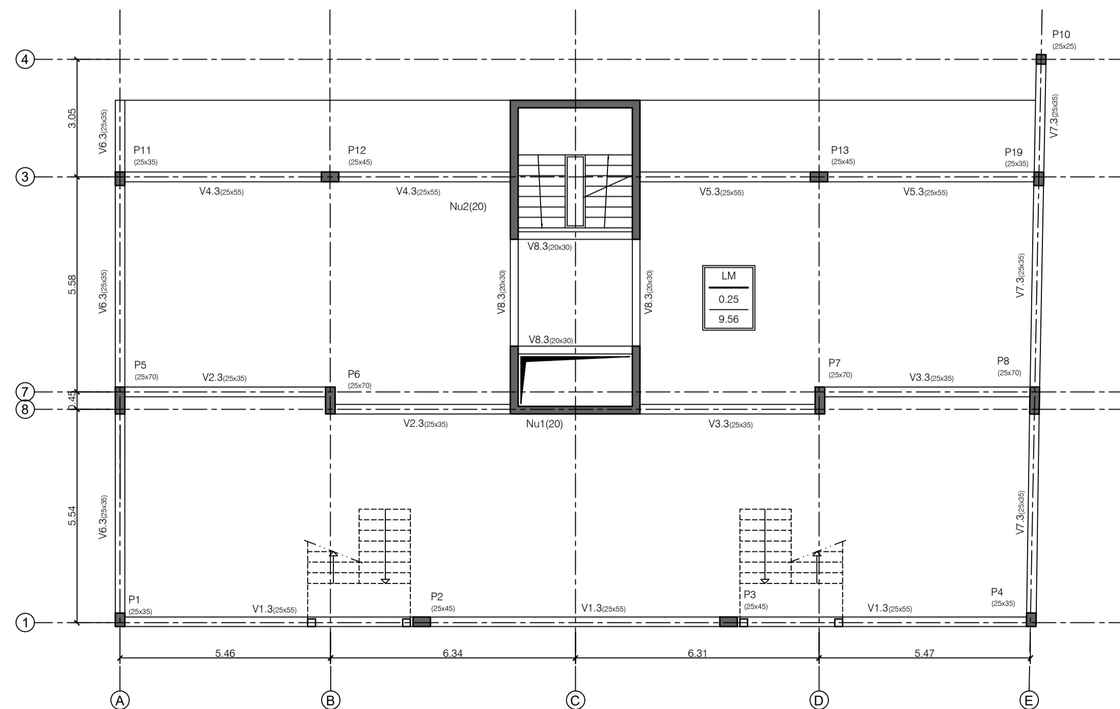
Planta Estrutural do Piso 3 Escala 1/100
