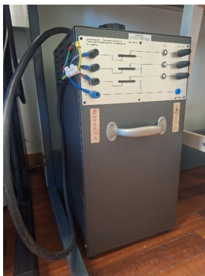
Figura 71 - Autotransformador utilizado para regulação tensão AC
