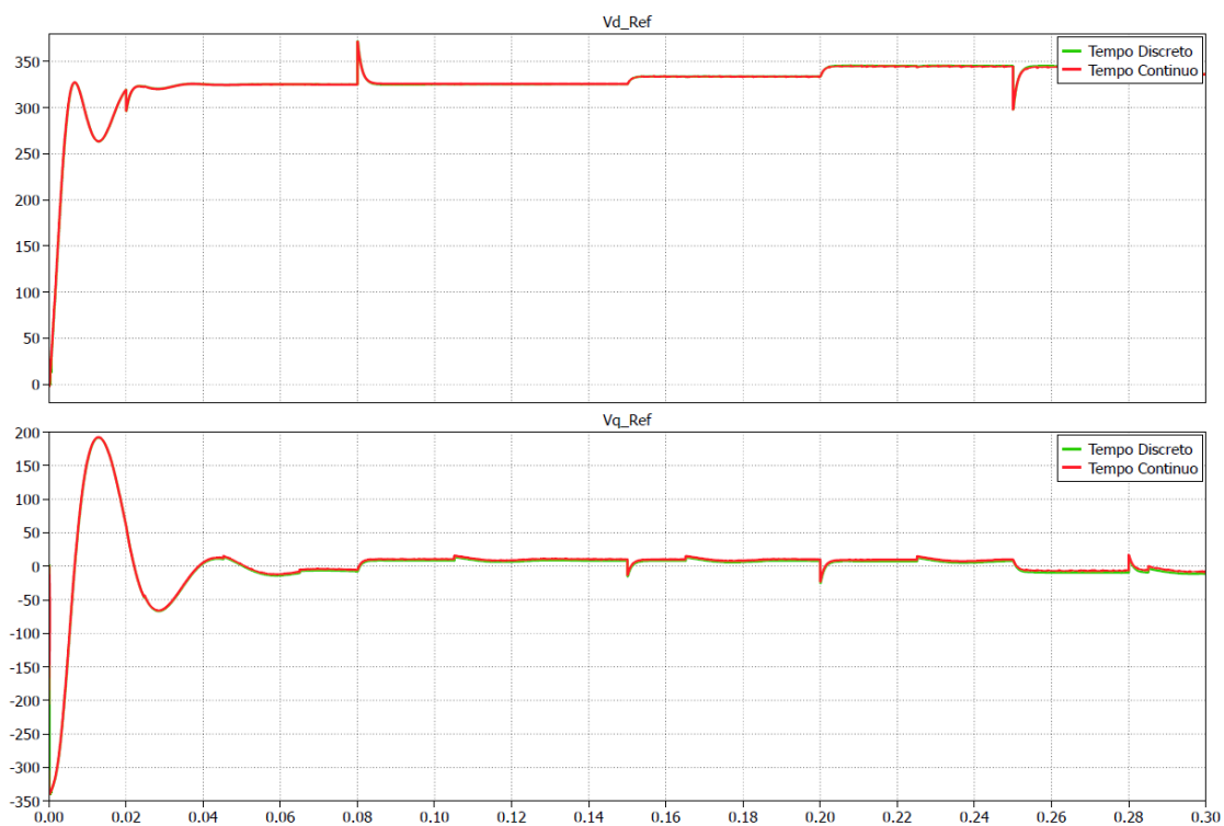
Figura 54 - Controle do conversor tempo discreto VS Tempo contínuo
