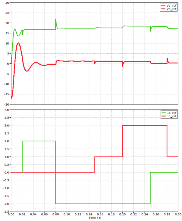
Figura 92 - Resultado controlo do conversor em Vd\_ref e Vq\_ref
