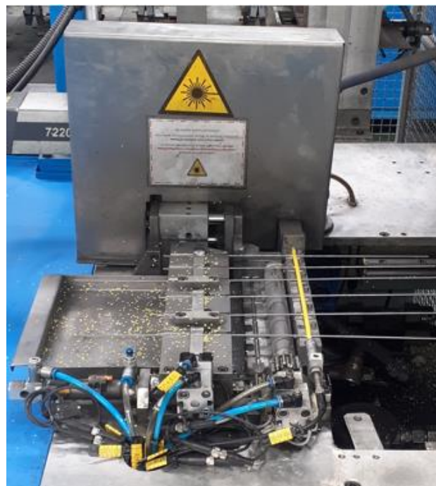
Figura 45 - Quantidade de material puncionado no posto 100
