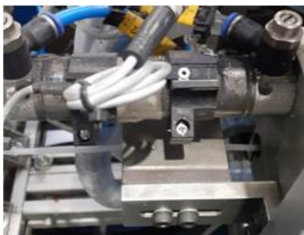
Figura 66 - Kit de inserção do tubo de revestimento do gancho sem o componente de guiamento
