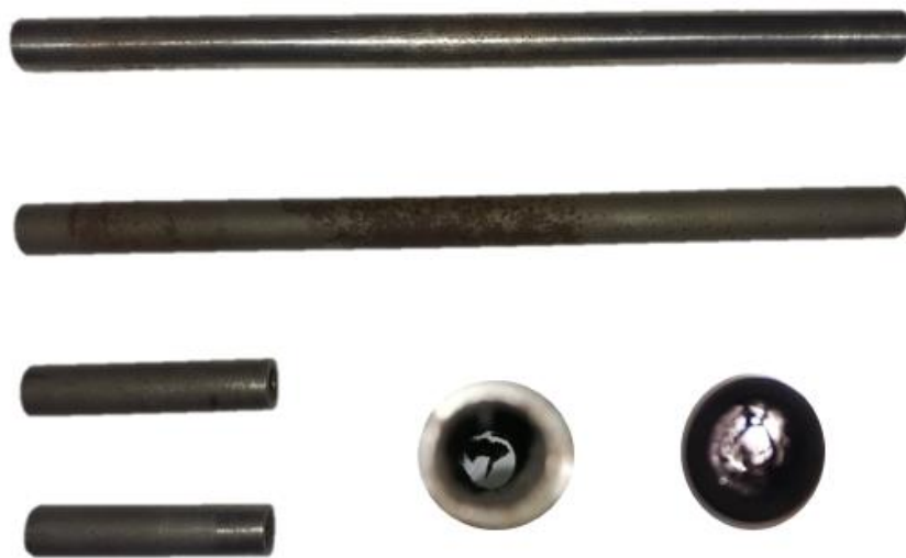
Figura 43 - Sujidade nas guias do tubo de revestimento de gancho
