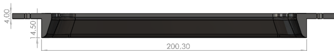
Figura 16 - Dimensões geométricas - Vista frontal em corte do adaptador
