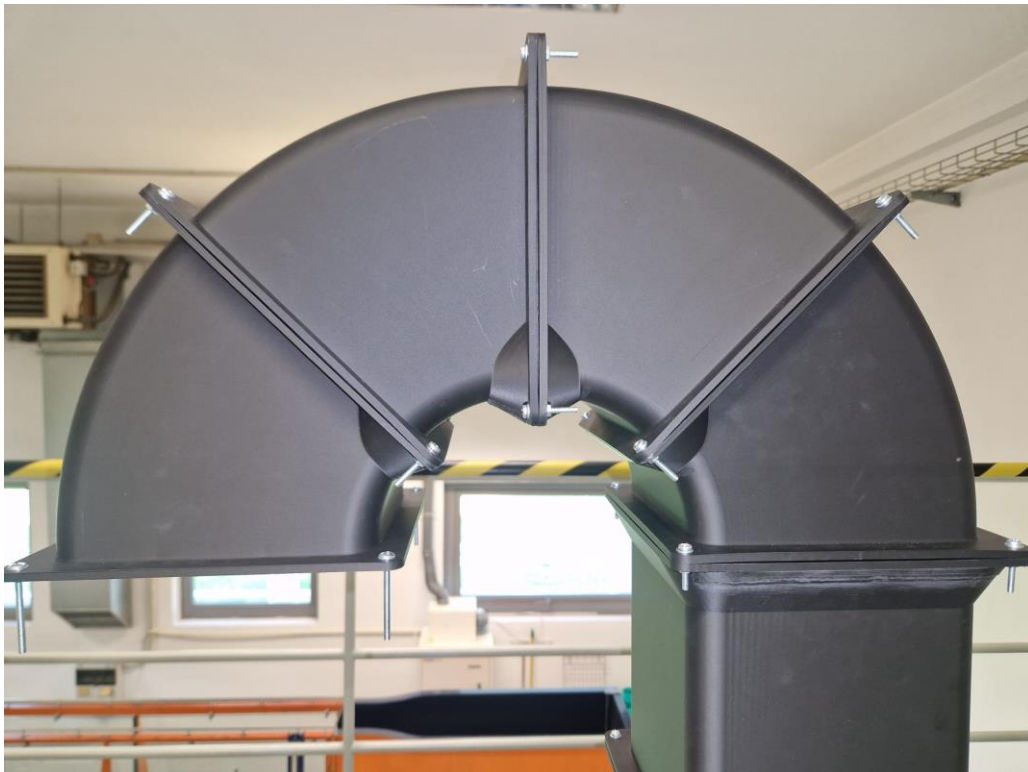
Figura 23 - Montagem das secções da curva
