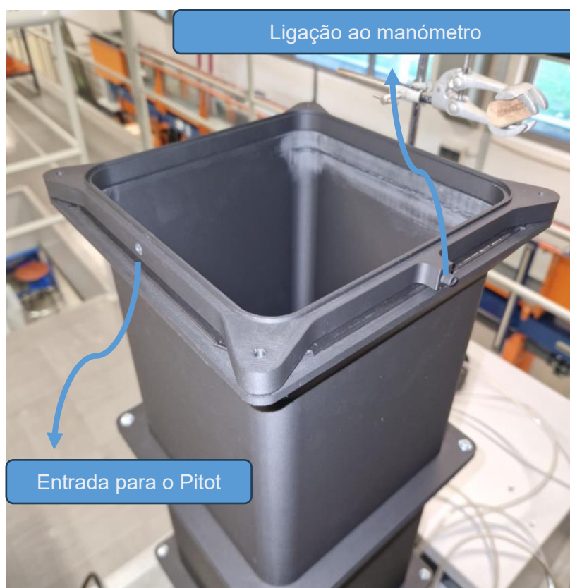
Figura 31 - Módulo de posicionamento de instrumentação
