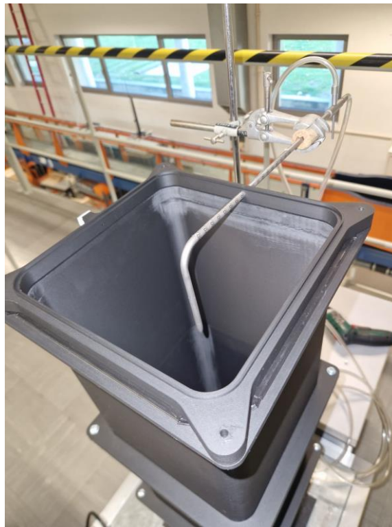
Figura 43 - Fixação da sonda de Pitot no interior túnel
