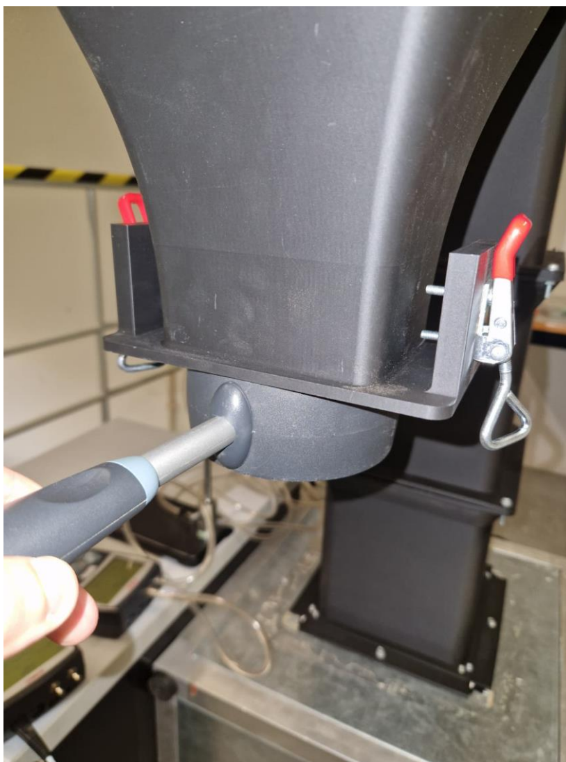
Figura 45 - Posicionamento do anemómetro de \varnothing 100 mm na zona de teste
