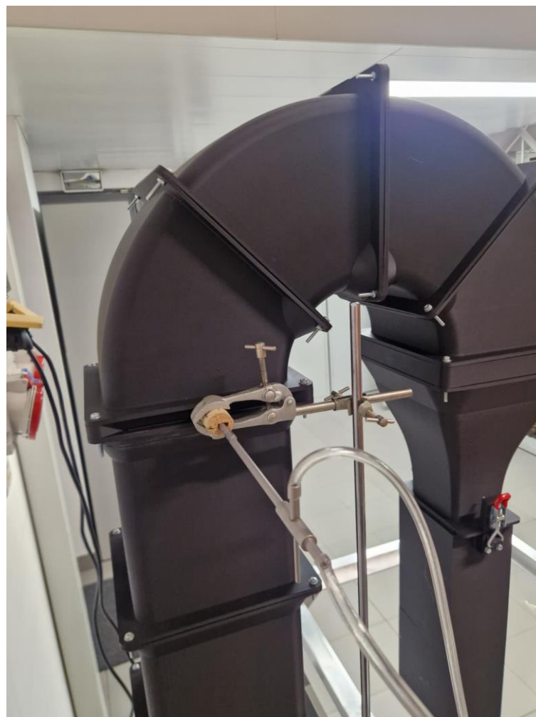
Figura 49 - Posicionamento do Pitot para medição das velocidades
