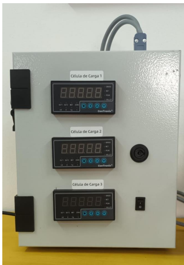
Figura 40 - Unidade de Controlo para leitura das forças e momento (Campos, 2025)
