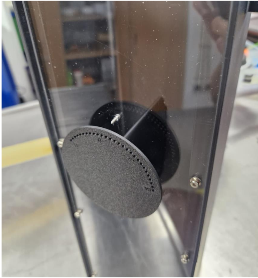
Figura 41 - Ligação do perfil NACA com variador de ângulo
