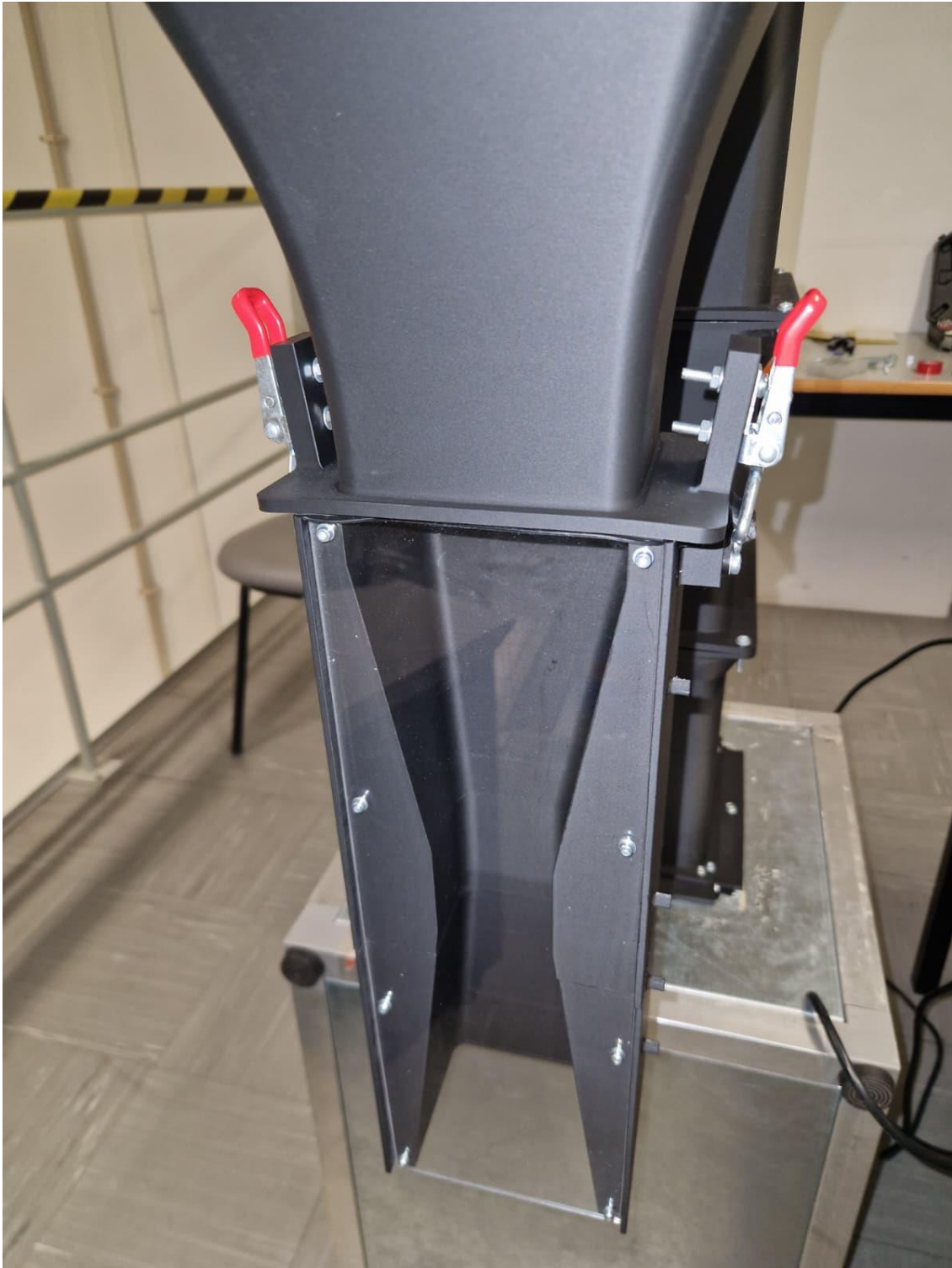
Figura 35 - Ligação do módulo de Venturi V1 à contração
