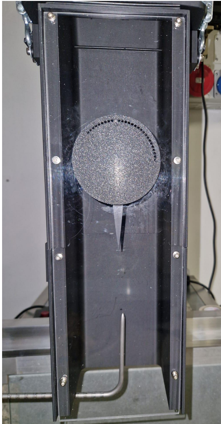
Figura 50 - Posicionamento do Pitot para medição das velocidades do perfil NACA
