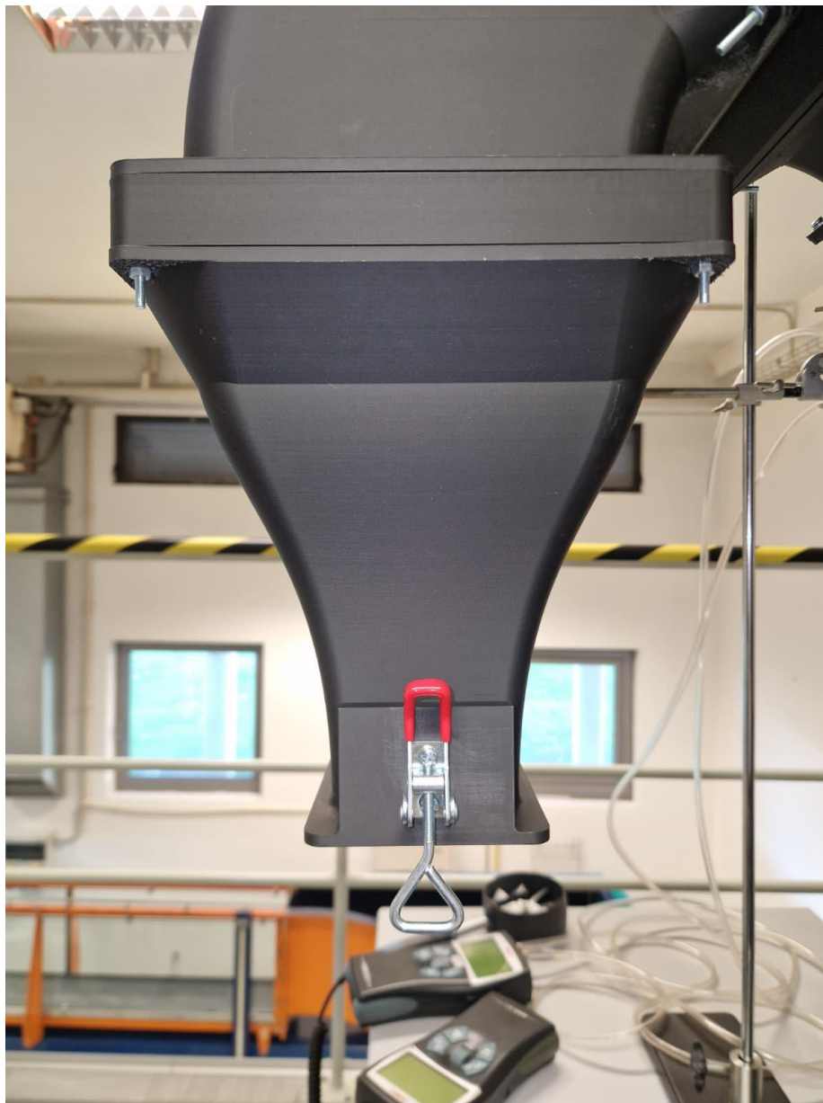
Figura 29 - Contração com grampos de fixação rápida
