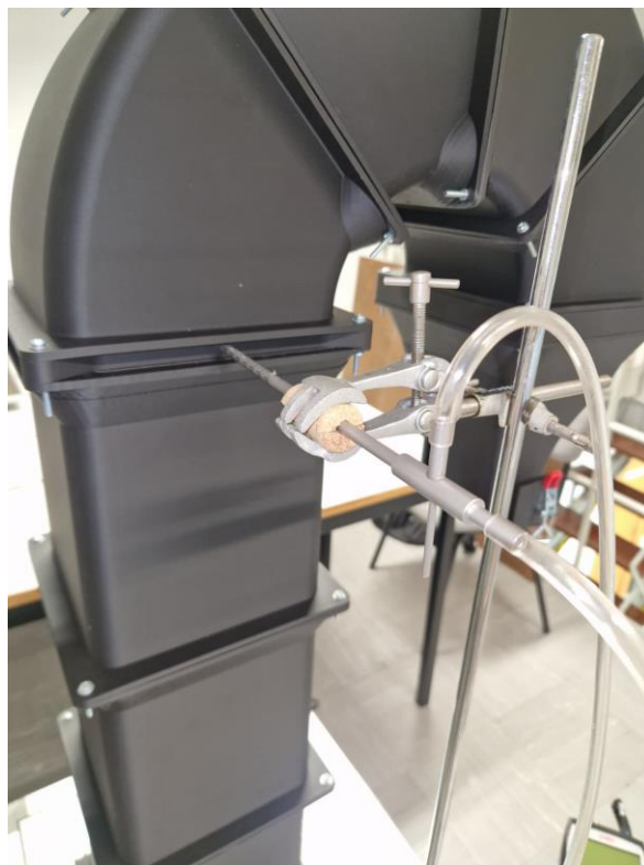
Figura 44 - Fixação da sonda de Pitot no suporte externo
