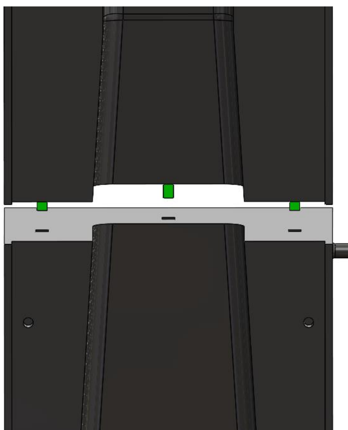
Figura 36 - Detalhe dos pinos de guiamento entre as secções do módulo
