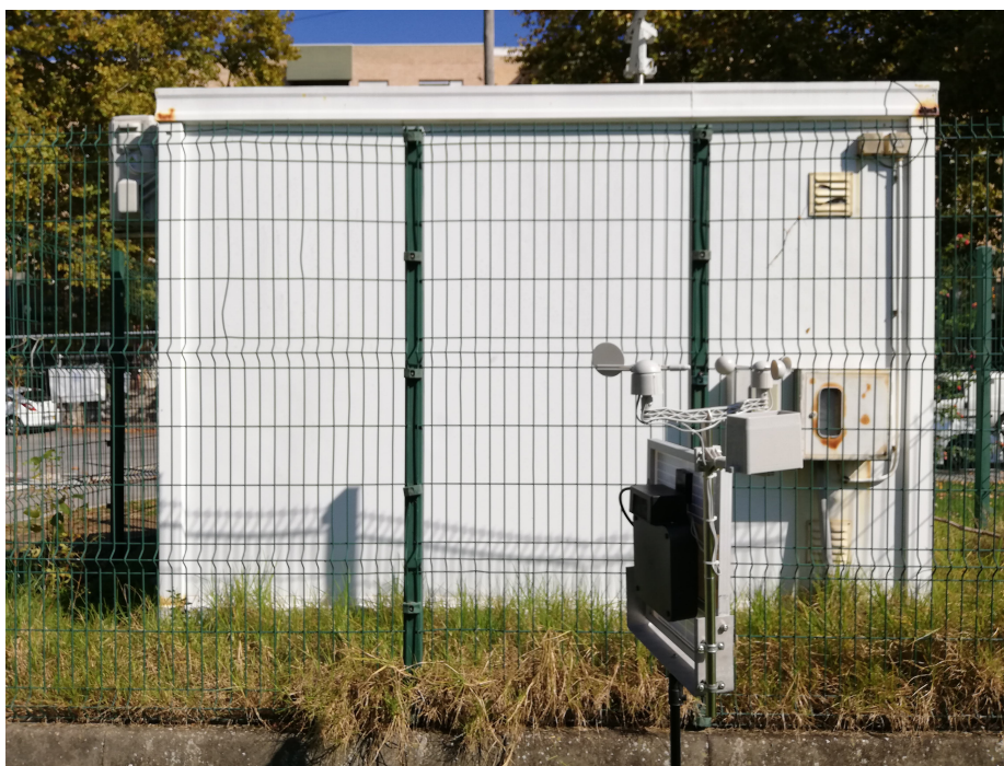
Figura 6.8: Sistema a recolher dados junto à estação de monitorização João Gomes Laranjo em Matosinhos
