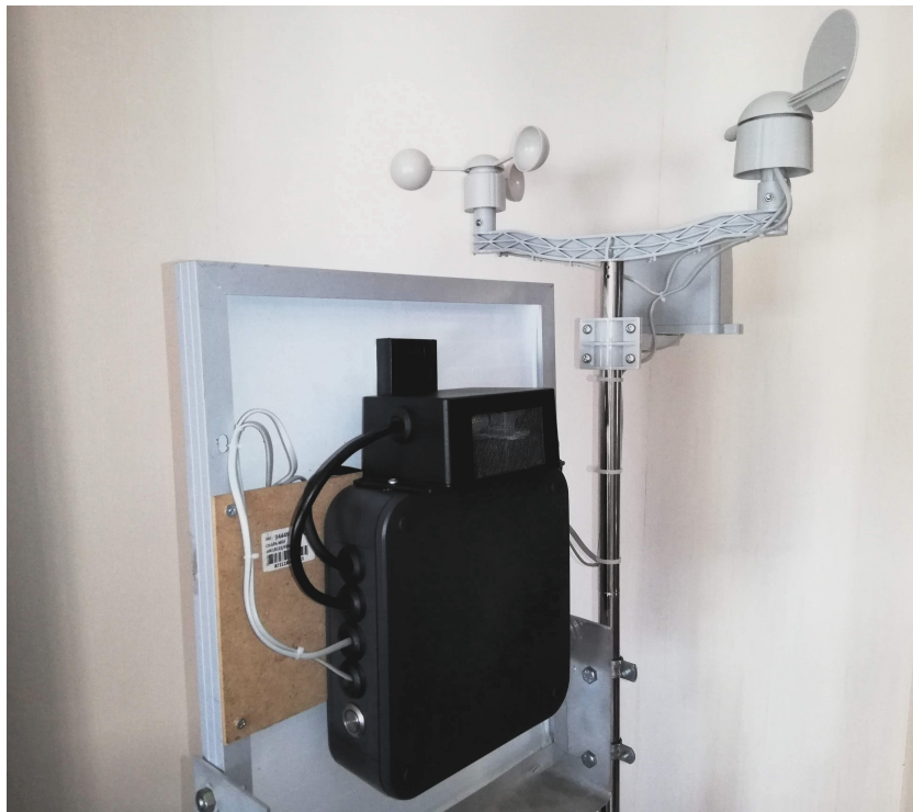
Figura 5.11: Protótipo da estação de monitorização completa
