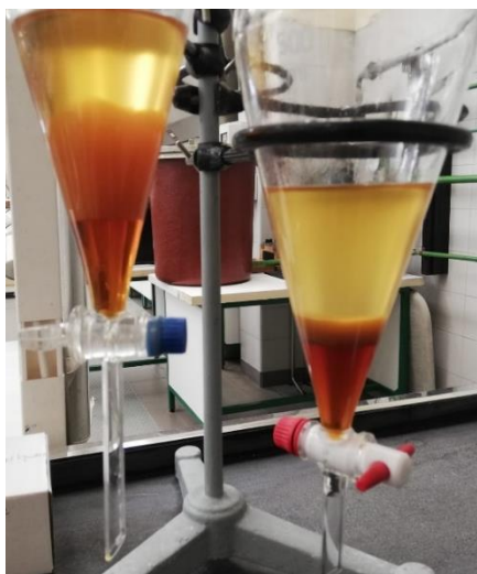
Figura 8 - Decantação para separação do subproduto (glicerol)
