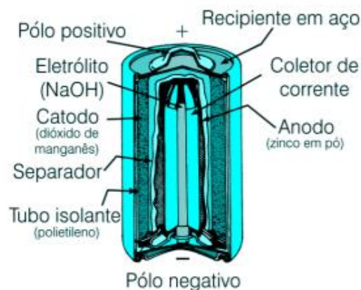
Figura 2 - Constituição de uma pilha alcalina (adaptado de [20])
