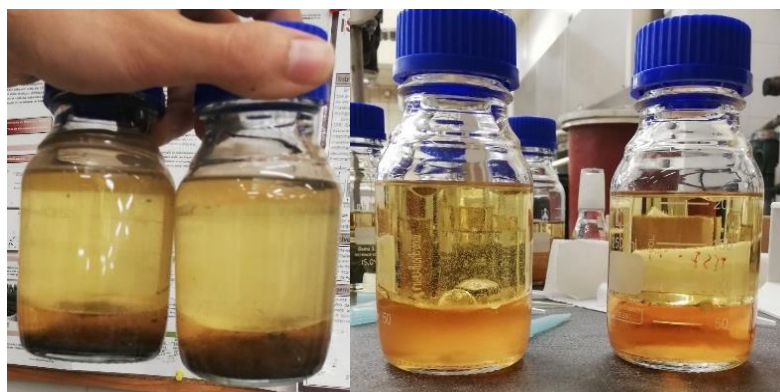
Figura 6 - Produto de reação antes (esquerda) e após (direita) a filtração
