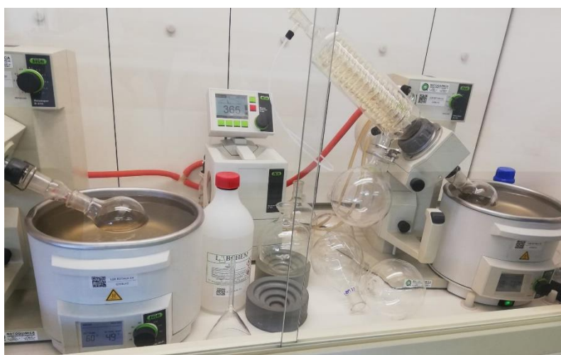
Figura 7 - Recuperação do excesso de metanol em rotavapor
