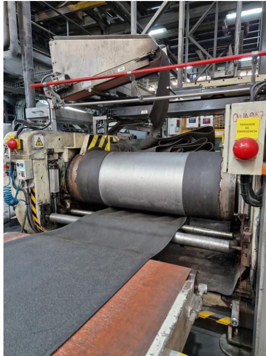
Figura 34 Admissão da banda no misturador aberto
