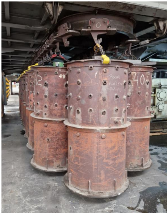
Figura 41 Moldes alinhados nos carris
