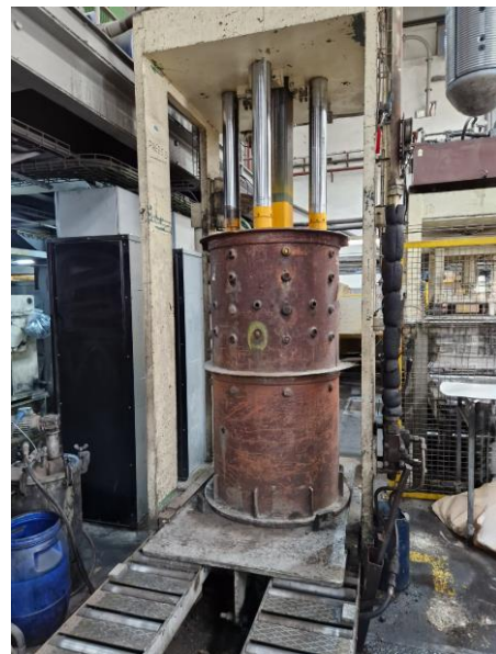
Figura 40 Prensagem do cilindro na prensa
