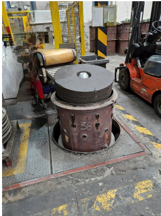
Figura 38 Empilhamento de rodas no molde
