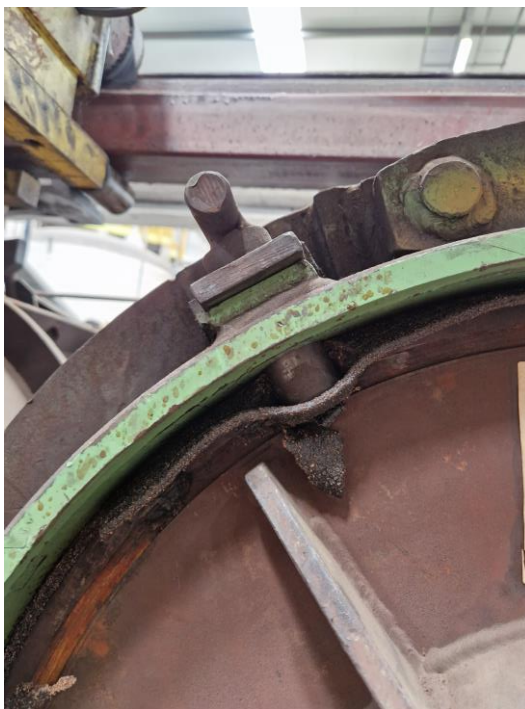
Figura 49 Resíduos de massa acumulados em volta das tampas e das cavilhas dos moldes
