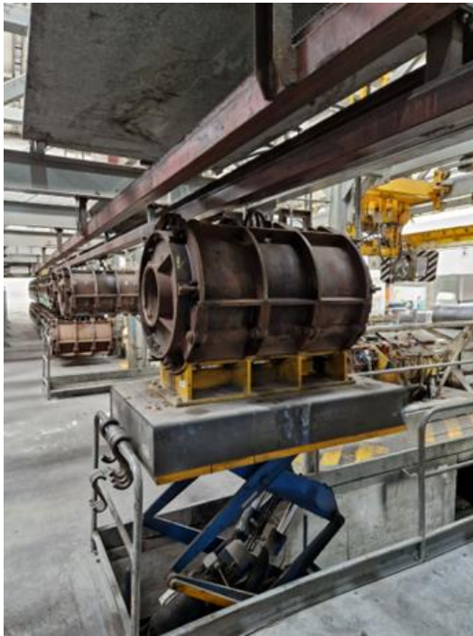
Figura 30 Colocação dos moldes nos carris
