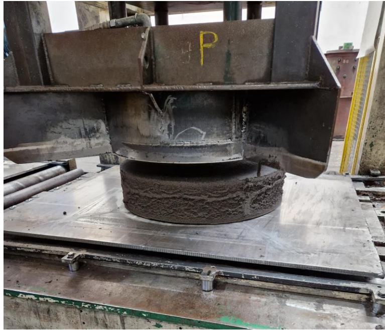
Figura 37 Prensagem e corte das folhas na prensa e formação da roda
