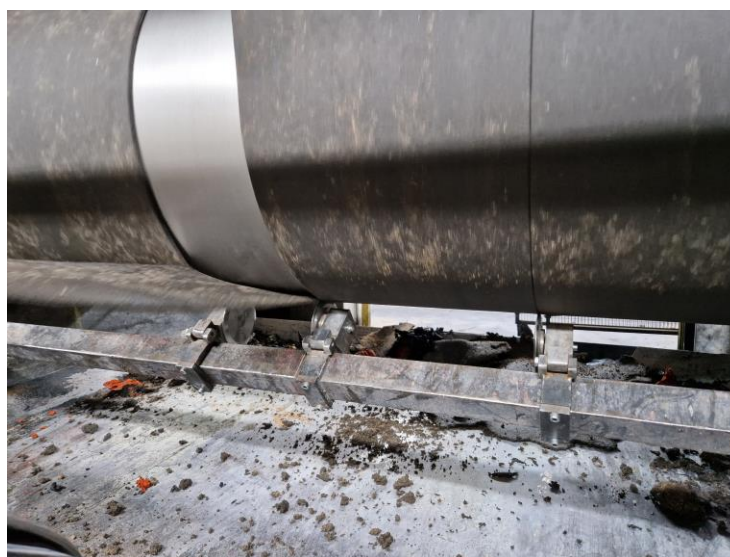
Figura 46 Novo mecanismo de suporte das facas do Gumix
