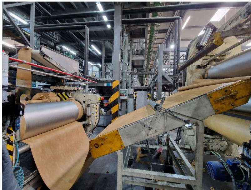
Figura 26 Passagem da massa do misturador aberto (lado esquerdo) para a calandra (lado direito)
