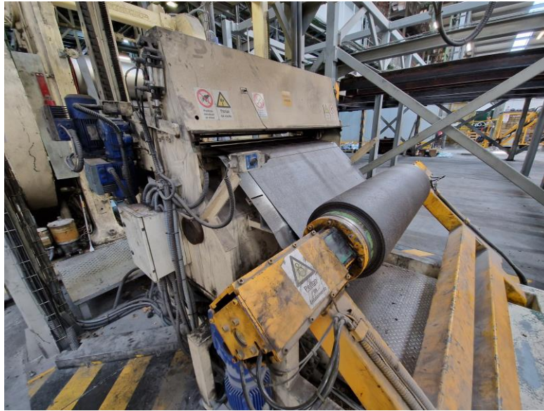
Figura 28 Saída da banda da guilhotina para o processo de enrolamento
