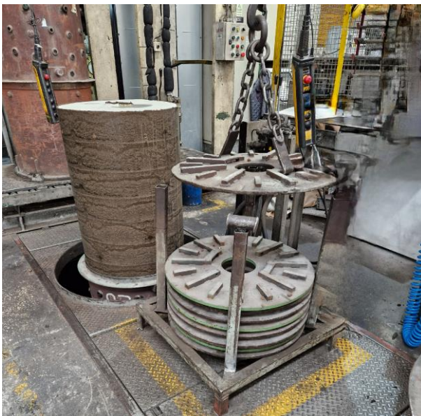
Figura 39 Manipulação das tampas dos moldes
