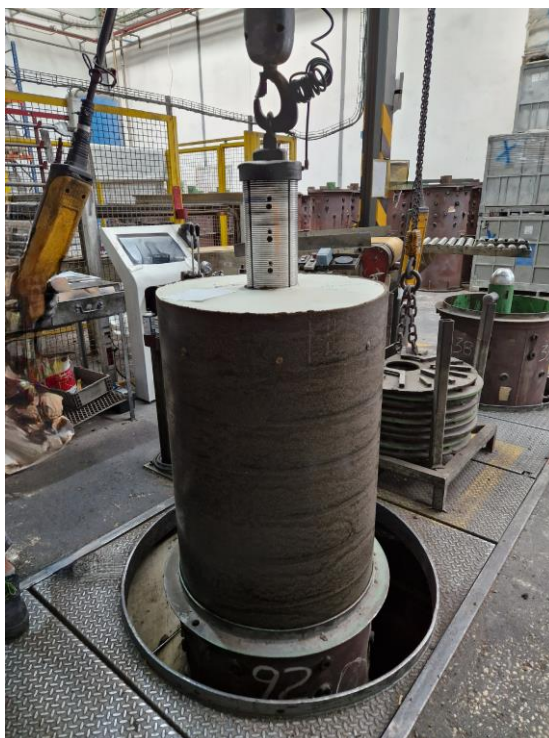
Figura 42 Desmoldagem do cilindro
