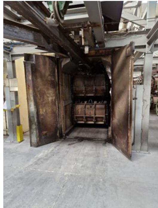
Figura 31 Colocação dos moldes na estufa
