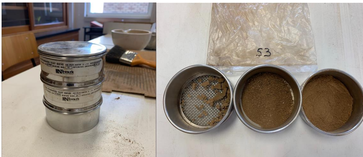
Figura 27 – Análise química elementar simplificada por fluorescência de RX – preparação da amostra de solo. Crivos utilizados e exemplo de crivagem de amostra de solo.
