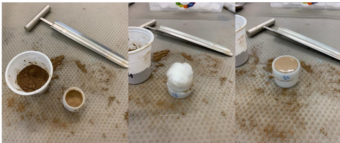
Figura 28 – Análise química elementar simplificada. Preparação dos provetes para leitura por fluorescência de raio-X.
