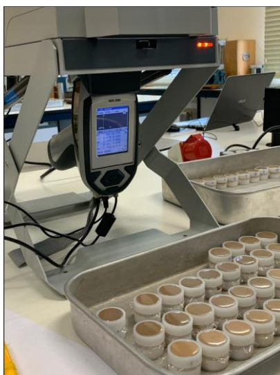
Figura 29 – Realização das leituras por fluorescência de RX
