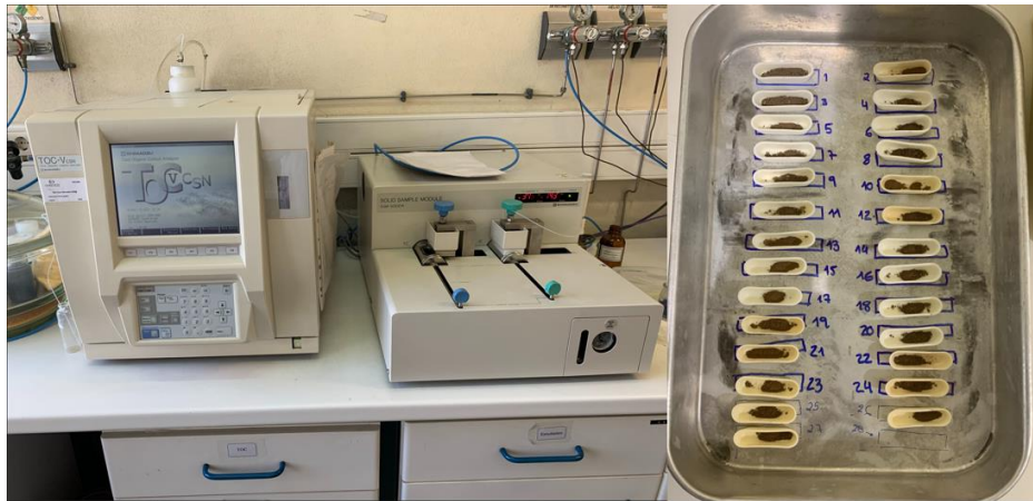
Figura 25 – Determinação do carbono orgânico total. TOC-Vcsn Shimadzu E200V (esquerda) e amostras prontas para a determinação do TOC (direita).
