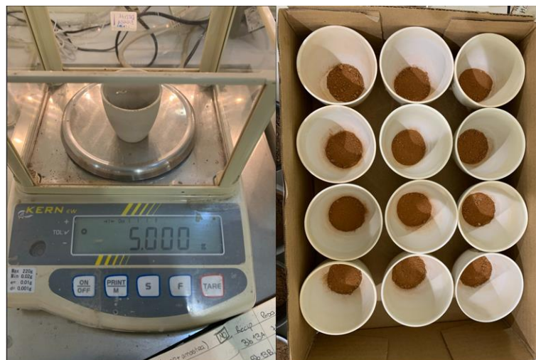
Figura 24 - Pesagem da amostra para a determinação da matéria orgânica (esquerda) e amostras após 4h na mufla.
