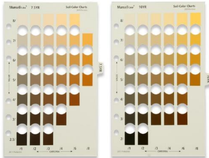
Figura 4 - Excerto da Carta de Cores de Munsell utilizada na identificação da cor dos solos. Fonte: https://www.torso.de/en/Color-Standards/Munsell-Colors/Munsell-Scientific-Colors/Munsell-Soil-Color-YR-Kit::417.html
