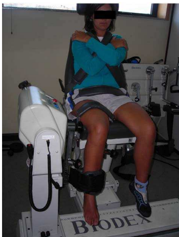
Figura 1. Posicionamento e formas de estabilização utilizadas no dinamómetro isocinético.
