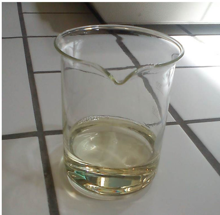
Figura 3.5 – Aspecto do produto obtido nas condições experimentais ótimas com catalisador \text{CaO-N}_2 após carbonatação e filtração.
