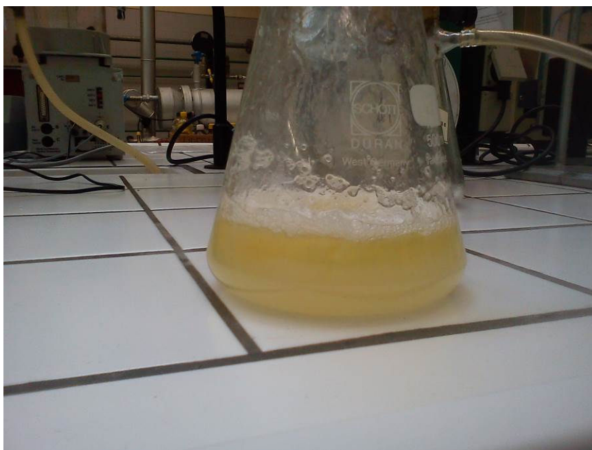
Figura 3.4 – Aspecto do produto obtido nas condições experimentais óptimas com catalisador \text{CaO-N}_2 após a carbonatação.
