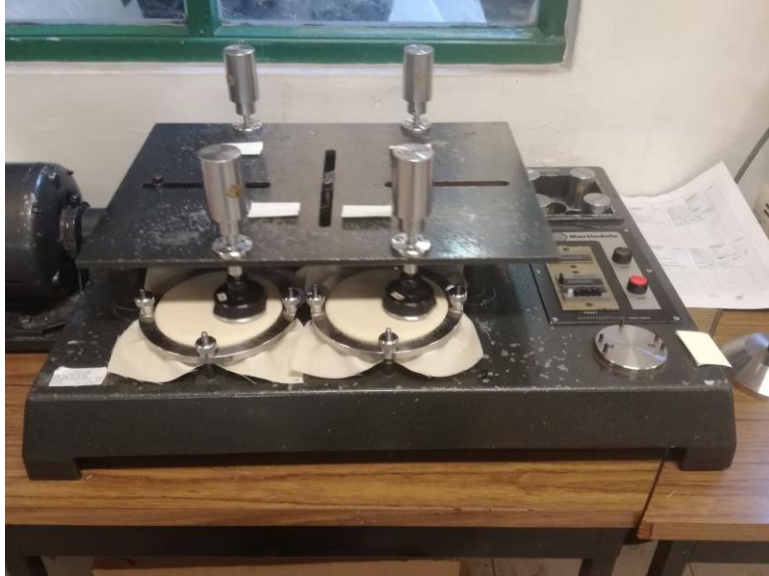
Figura 3.6- Equipamento utilizado na realização do Teste de Abrasão Martindale.
