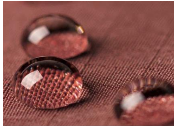
Figura 2.7- Gotas de água num tecido acabado com um repelente à água (Kiron, 2014).
