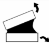
Figura 4 - Junta sujeita a esforços de clivagem [1]
