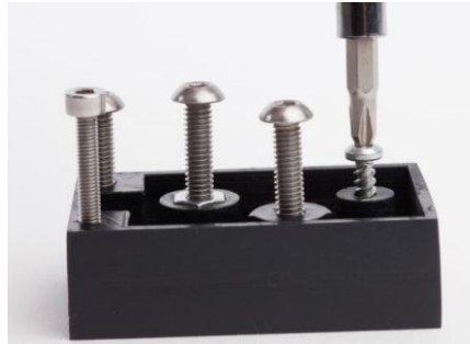
Figura 19 - Exemplos de ligações roscadas em elementos impressos [99]
