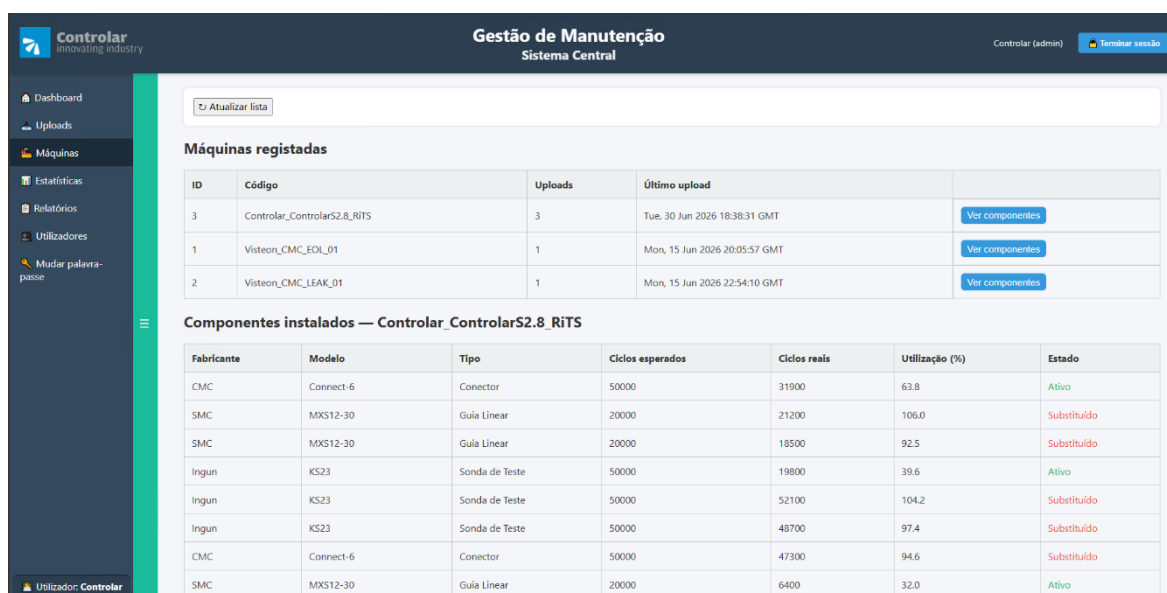
Figura 34 – Máquinas registadas e componentes da instância RiTS com ciclos de vida concluídos. Os componentes substituídos, com utilizações acima de 100%, como o SMC MXS12-30 a 106% e a Ingun KS23 a 104.2%, são os que contribuem para o cálculo estatístico de vida útil real, por representarem ciclos completos com valor observacional concreto.
