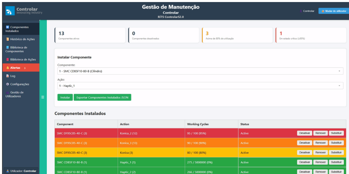
Figura 28 – Tabela de componentes com codificação cromática por nível de utilização
