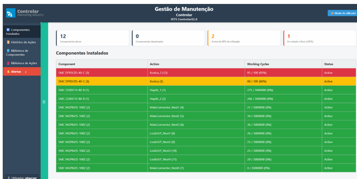
Figura 25 – Componentes instalados com ciclos reais acumulados (perfil observador)
