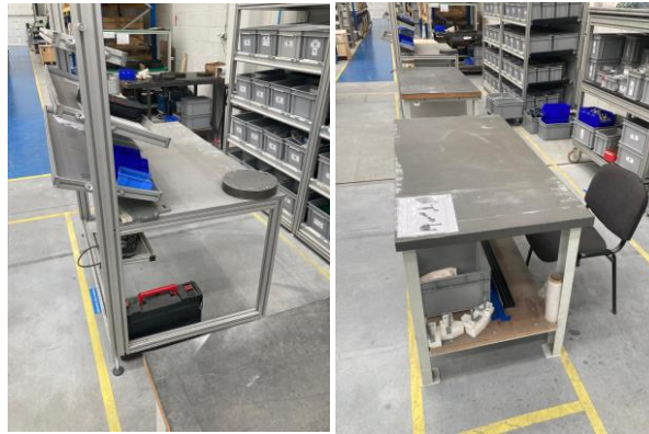
Figura 15 - Bancadas de trabalho para pré-montagens
