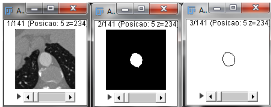
Fig. 3.11: Plano perpendicular à artéria aorta, imagem segmentada por crescimento de regiões e o contorno correspondente obtido pelo método de Watershed , respectivamente.
