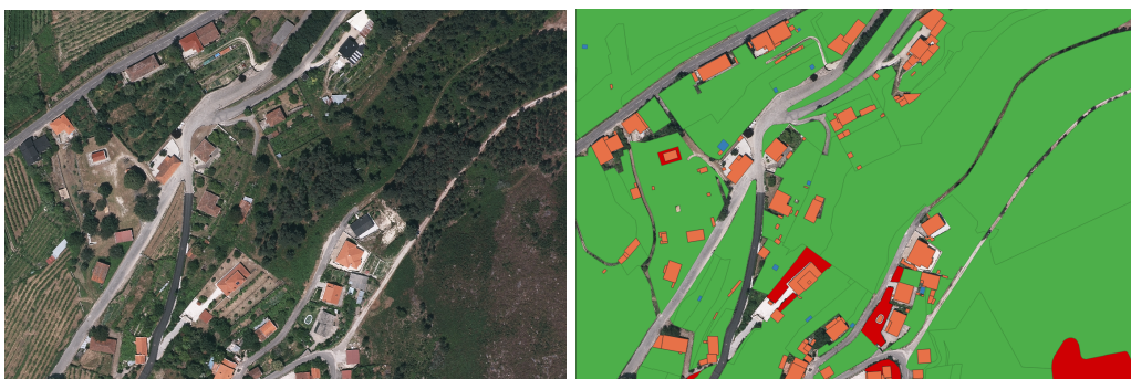
Figura 2.1: Exemplo de fotografia aérea (esquerda) e visualização da informação disponíveis nos shapefiles para a mesma (direita).
