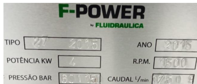
Figura 55 - Características da unidade hidráulica
