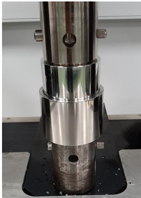
Figura 51 - Ensaio de compressão do granulado
