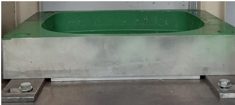
Figura 38 - Fixação de moldes de grandes dimensões
