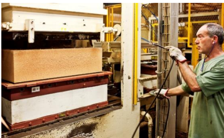
Figura 7 - Moldação de Blocos em Contínuo
