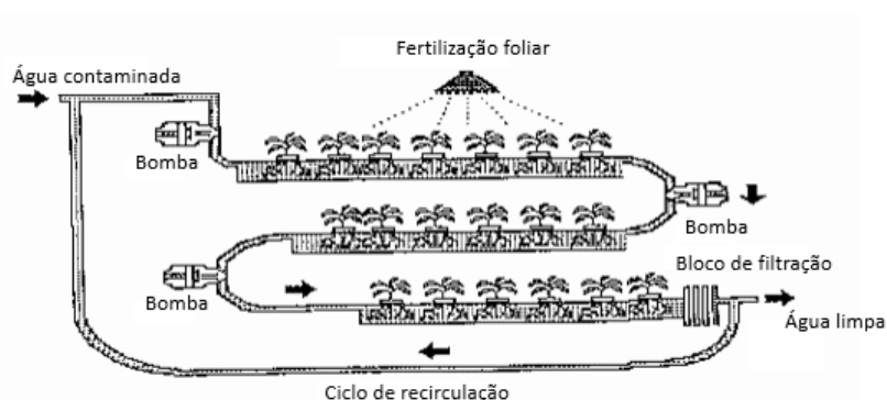
Figura 3 - Sistema de rizofiltração (Adaptado de: [34]).
