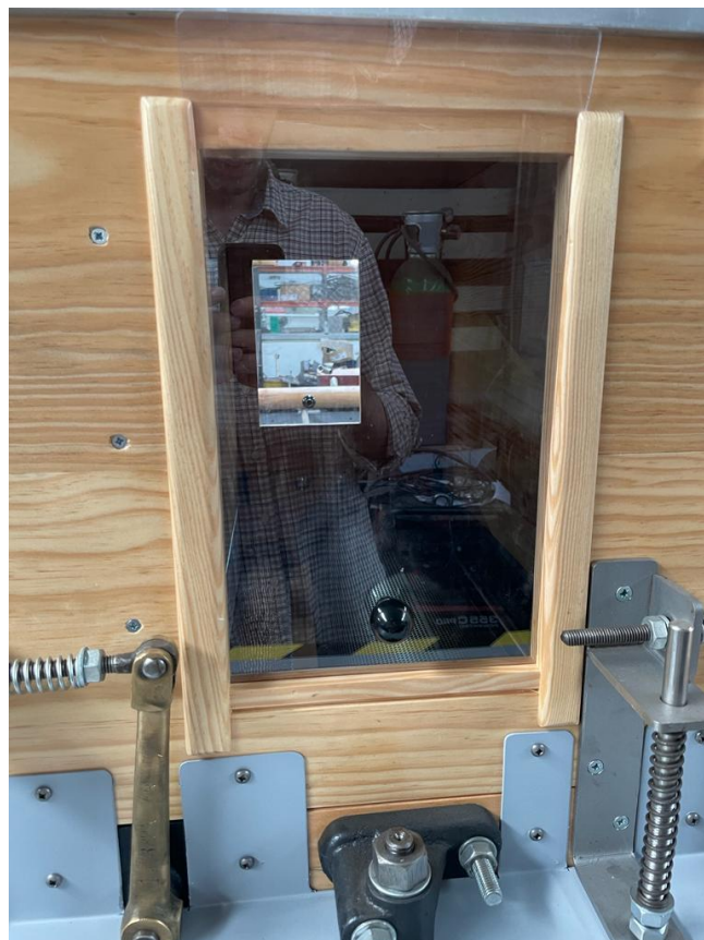
Figura 32- Janelas em Policarbonato.
