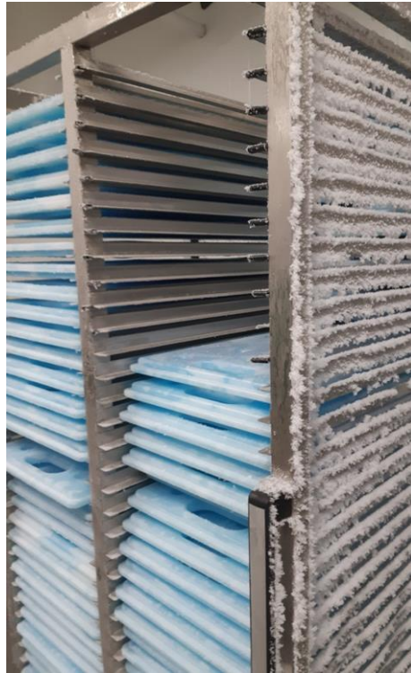
Figura 8- Colocação das Placas Entéticas nos Dolis de transporte para arcas de congelação
