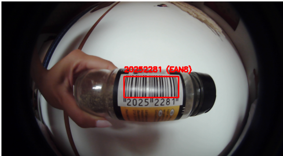
Figura 4.2: Comportamento do algoritmo na deteção de um produto
