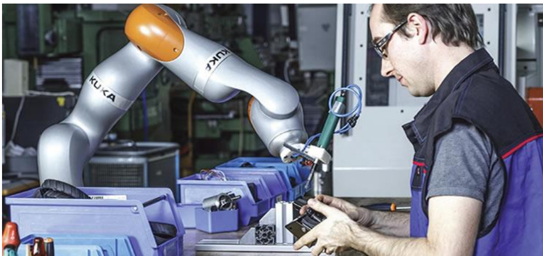
Figura 10 - Robô colaborativo desempenhando funções com um operador [29].
