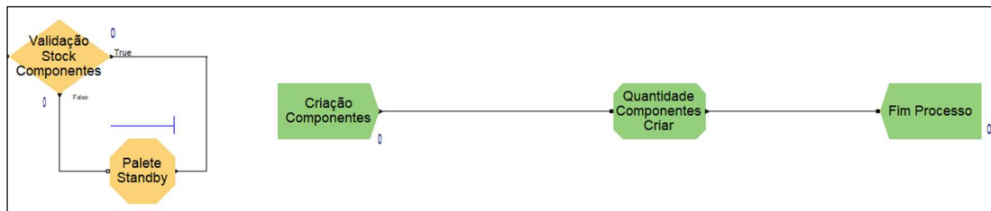
Figura 40 – Mecanismo de controlo de stocks e processo de reabastecimento Fonte: PrintScreen do Software Arena
